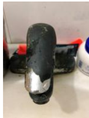
H 2 S ăn mòn vòi nước do hở KSH gây ra
