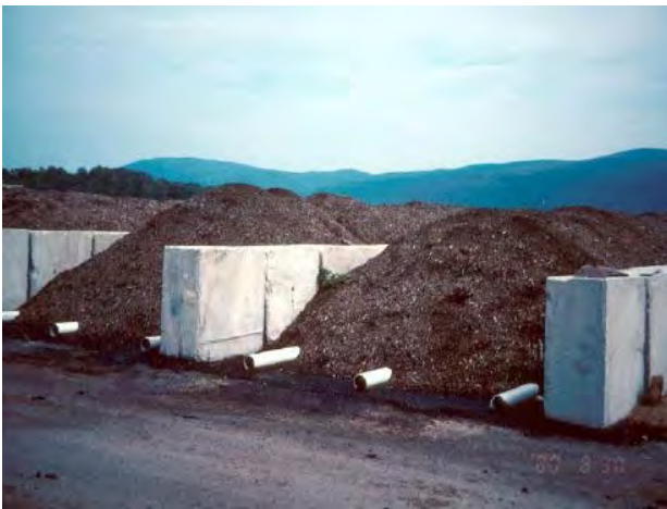
Hình 3.3.14. Luống ủ ngang có hệ thống thông khí
