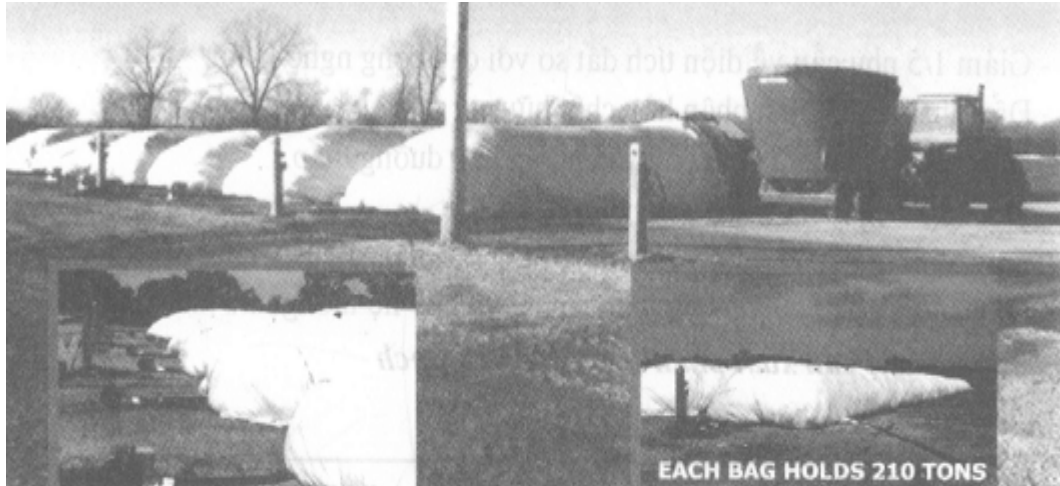
Hình 3.3.12. Công nghệ Compost Lemna bao đựng trên 210 tấn, có máy điều hành nhiệt độ và oxy
