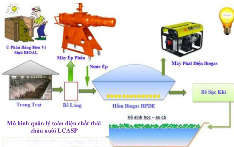
Hình 2: Mô hình quản lý toàn diện chất thải chăn nuôi LCASP
