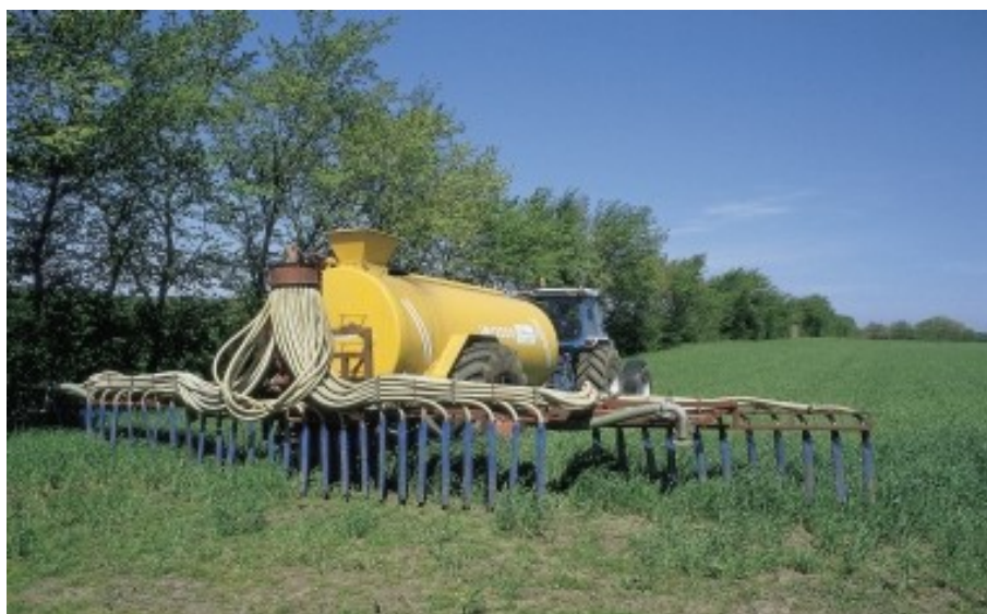
Xe bồn với hệ thống phun chất thải lỏng vào các rãnh bừa
