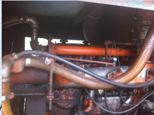
Chế hòa khí và bộ chuyển đổi cho máy diesel dùng KSH
