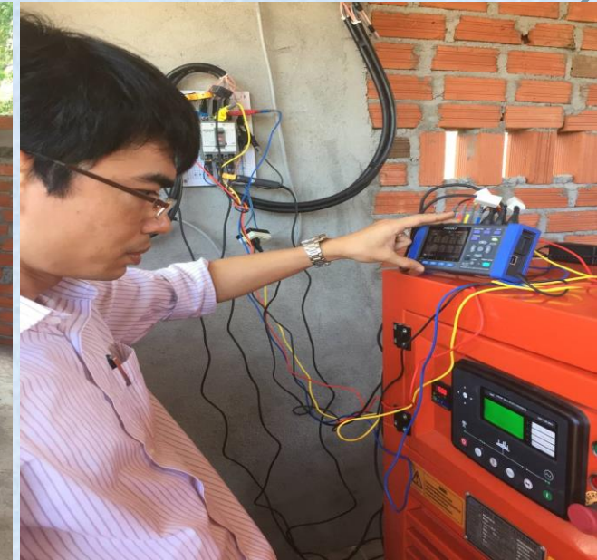
Đo công suất điện của máy phát bằng cách lắp đặt thiết bị chuyên dụng
