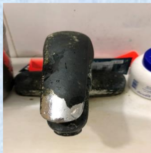
H_2S ăn mòn vòi nước do hồ KSH gây ra
