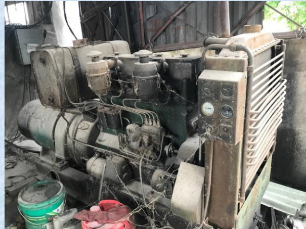
Máy phát điện có bộ phận chuyển đổi để chạy lưỡng nhiên liệu (diesel và KSH) tại Nam Định
