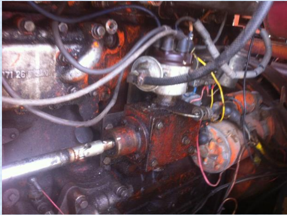
Cụm điều khiển thời điểm kích nổ trên máy phát điện chuyển đổi dùng khí sinh học từ máy diesel 215 kVA ở Bình Định
