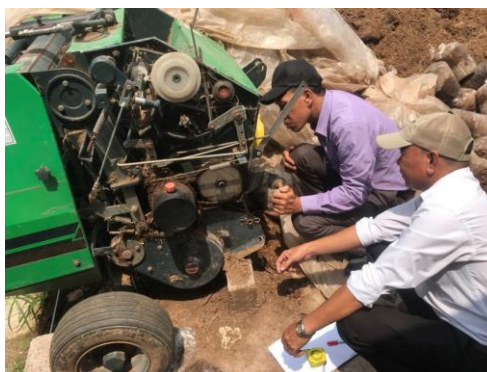
Hình 13: Lắp đặt và chạy thử nghiệm bộ phân cuộn rơm tại xưởng thí nghiệm
