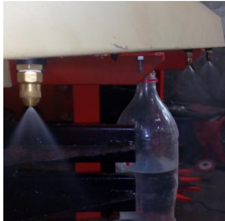
Hình 12: Thử nghiệm bộ phận phun sương tại xưởng thí nghiệm
