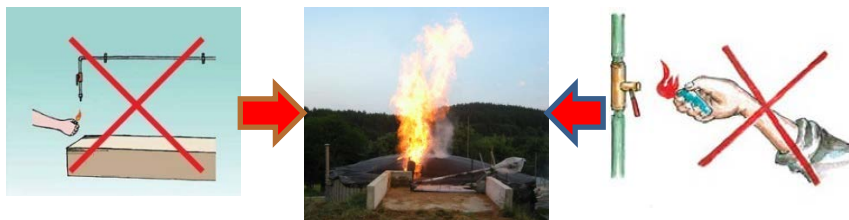
Hình 2.4 - Không châm lửa tại đầu ống dẫn khí và van khóa chính
