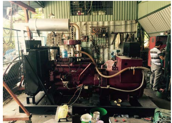
Máy phát điện chạy bằng KSH được cải tạo từ động cơ diesel của Cơ sở Hoàng Lang
