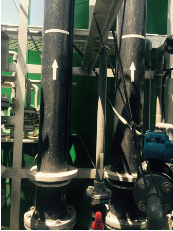
Bộ lọc H 2 S của mô hình nghiên cứu xử lý bùn thải ao nuôi tôm
