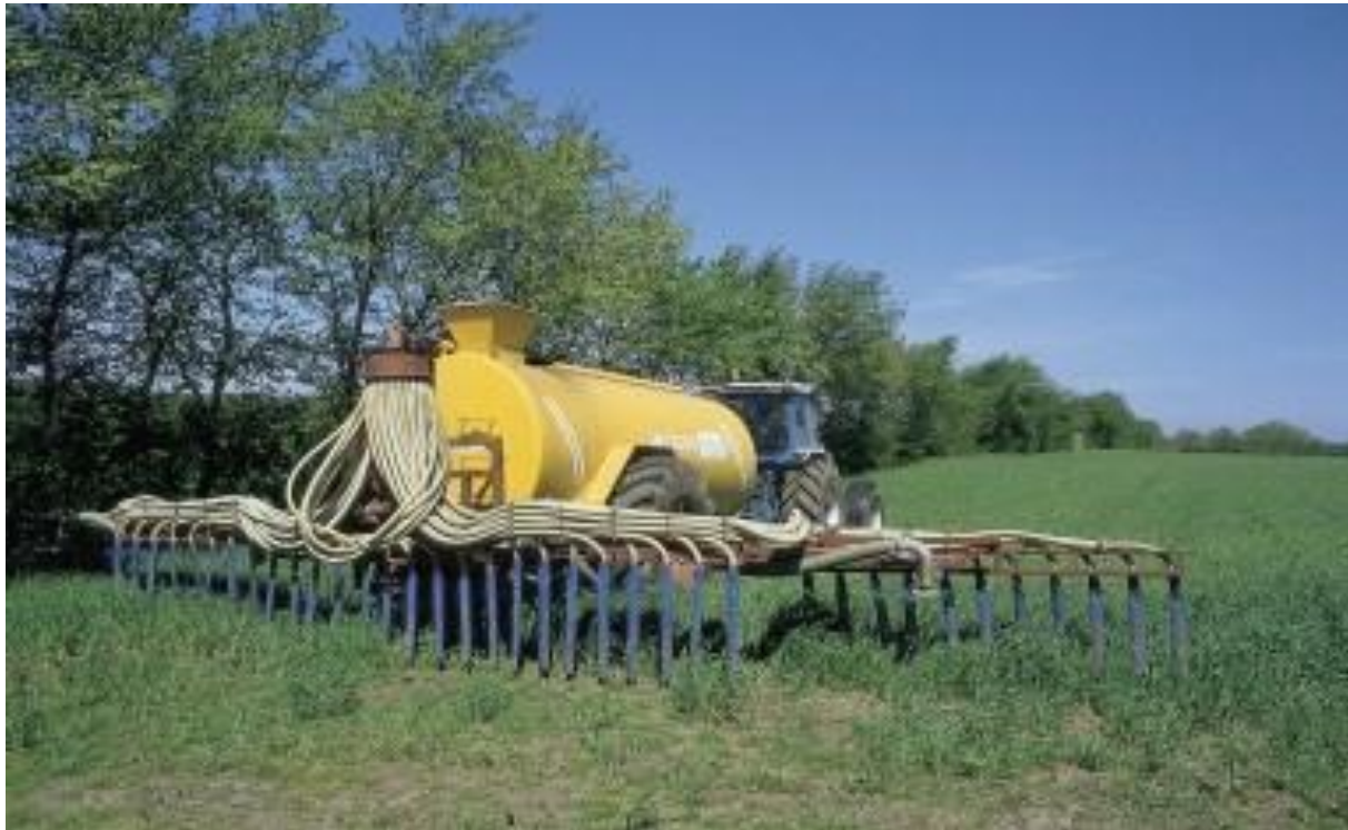
Xe bồn với hệ thống phun chất thải lỏng vào các rãnh bừa
