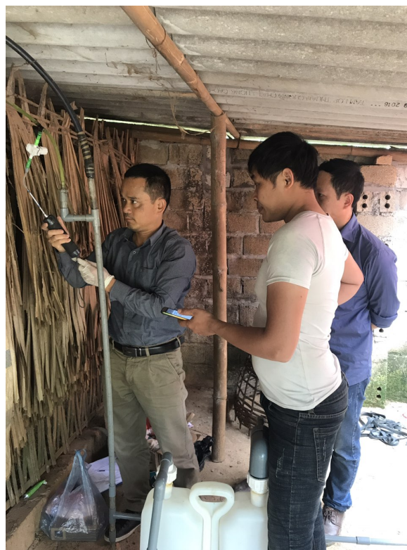
Hình 5: Hình ảnh kỹ thuật viên tiến hành đo đánh giá chất lượng KSH
