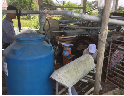
Hình 3: Một số hình ảnh bộ tinh lọc cho máy phát điện KSH
