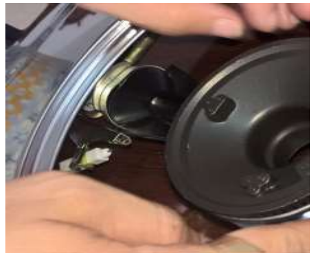
Hình 2.2.24. Gắn ống điều vào thân bếp
