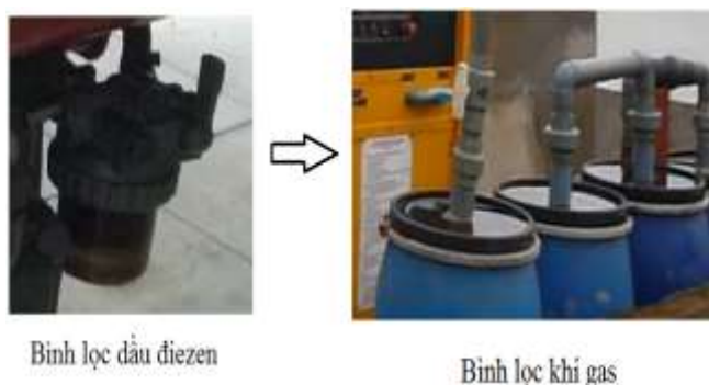
Hình 1.50. Bình lọc dầu diesel và bình lọc khí KSH
