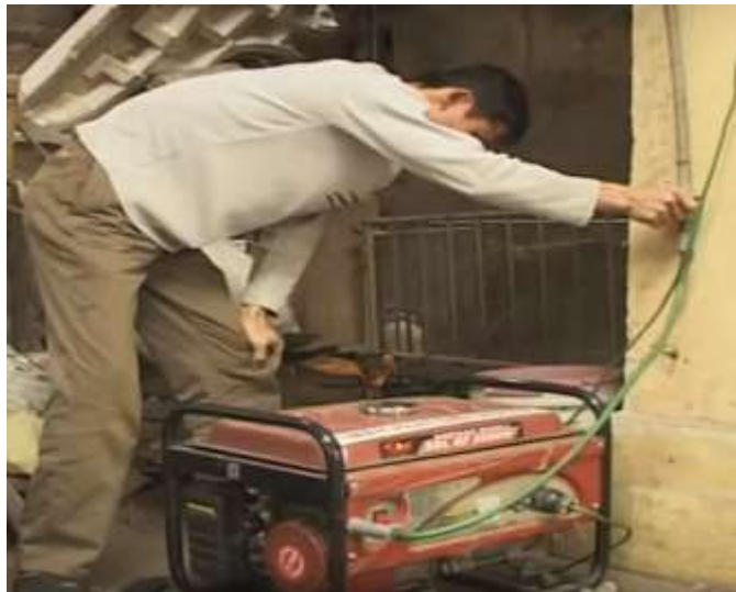
Hình 3.26. Điều chỉnh van cấp khí biogas
