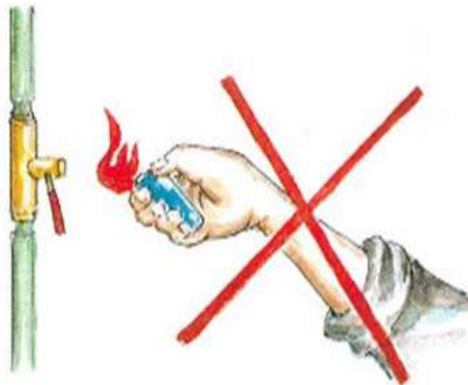
Hình 1.1.10. Cấm lửa tuyệt đối khi KSH bị rò rỉ
