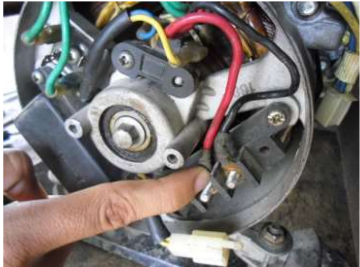
Hình 5.32. Lắp nguồn 220 VAC
