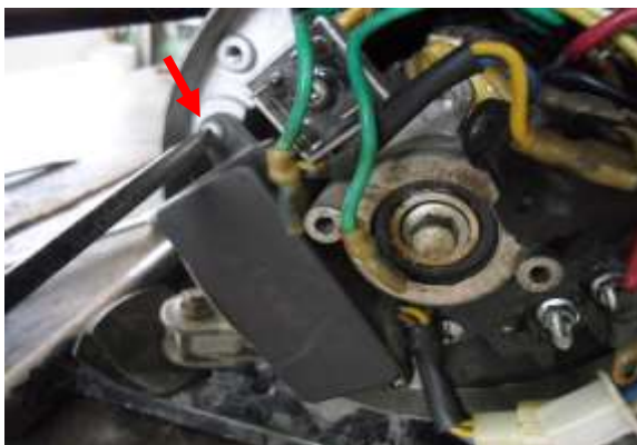
Hình 5.13.a. Tháo ốc cố định bộ tự động điều chỉnh dòng kích từ
