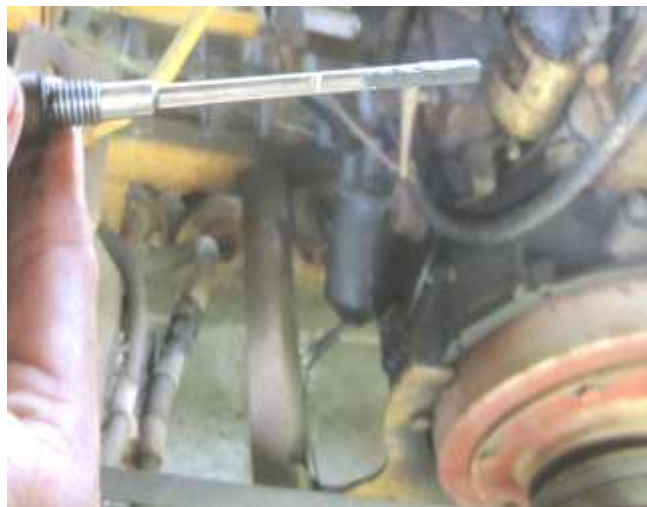
Hình 3.16. Kiểm tra chất lượng nhớt
