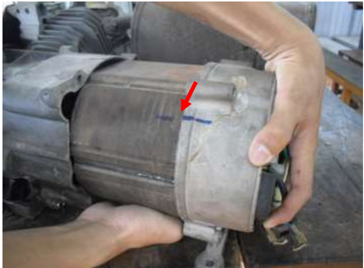
Hình 5.23. Lắp nắp trước vào stato
