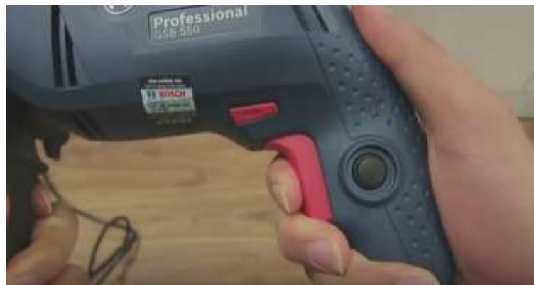
Hình 1.29. Kiểm tra nút khởi động máy khoan
