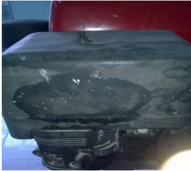
Hình 1.61. Lắp bộ lọc không khí mới vào động cơ
