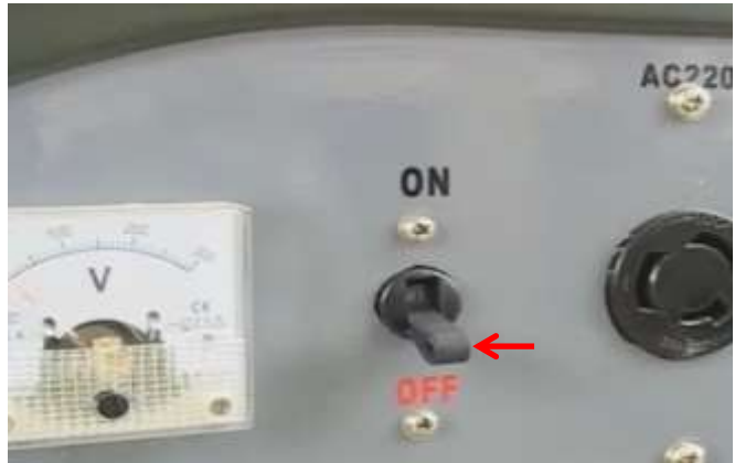
Hình 4.4. CB tổng của tổ máy phát điện phải ở vị trí tắt (OFF) khi chuẩn bị khởi động
