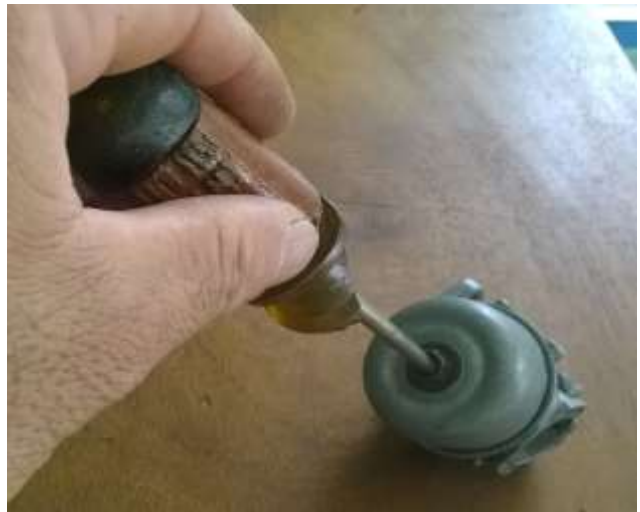
Hình 1.56. Lắp nắp chế hòa khí
