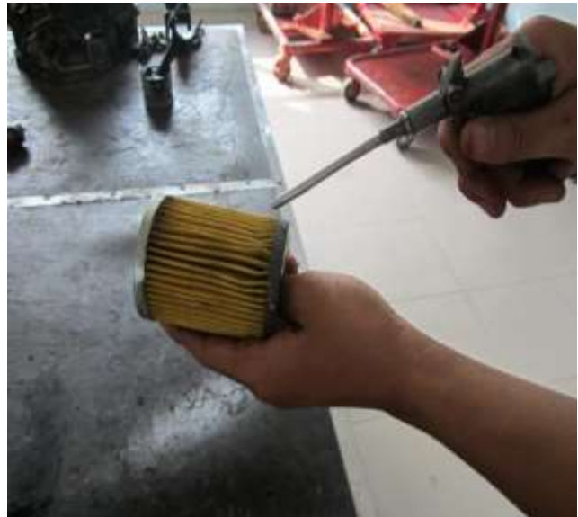
Hình 7.5. Dùng khí nén làm sạch bụi bẩn
