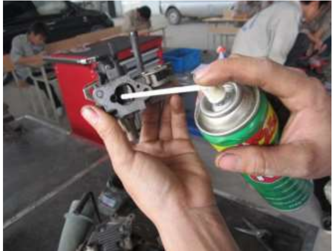
Hình 7.25. Dùng chất tẩy rửa xịt vào các đường ống dẫn bên trong
