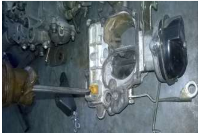
Hình 1.55.b. Lắp van kim và đế van kim
