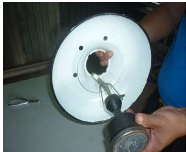
Hình 2.3.32. Lắp tán đèn
