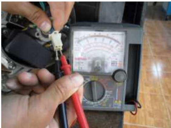
Hình 5.42.b. Đo thông mạch cuộn dây cấp nguồn cho bộ tự động điều chỉnh dòng kích từ
