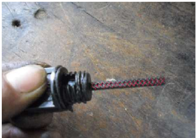
Hình 4.3. Kiểm tra mức nhớt của động cơ
