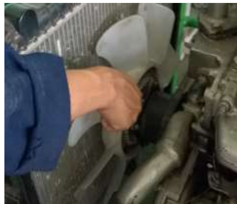
Hình 3.22. Siết chặt bu lông bắt pu ly với truyền động đai
