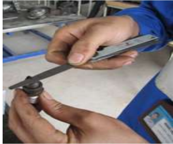
Hình 4.25. Dùng thước lá kiểm tra khe hở điện cực bugi
