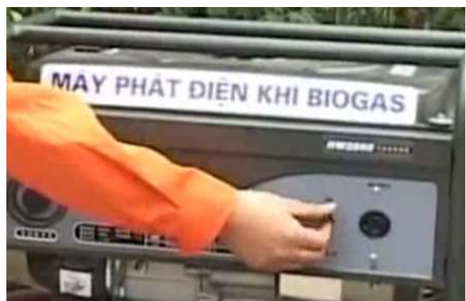
Hình 7.36. Bật cầu dao tải sang vị trí ON
