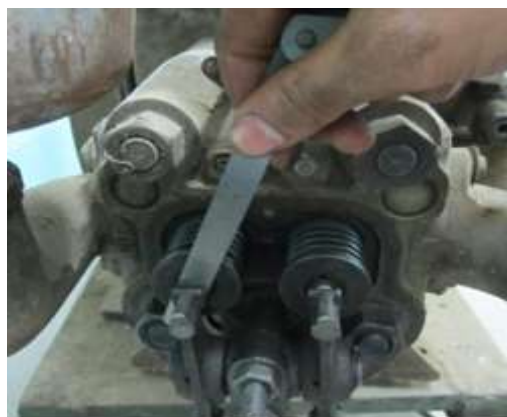
Hình 6.24. Kiểm tra khe hở nhiệt
