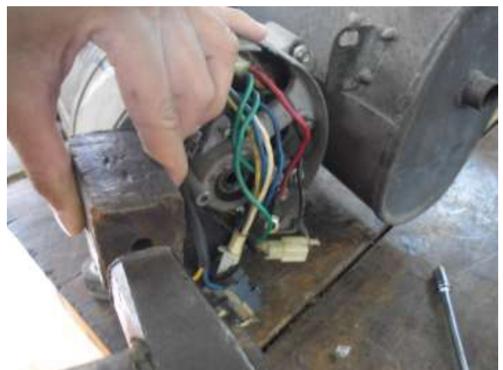
Hình 5.25. Ghép chặt nắp với stato
