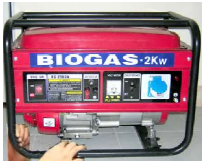
Hình 2.11. Đặt động cơ vào giá đỡ
