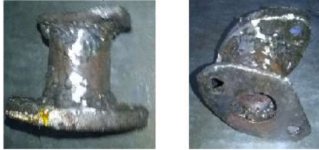
Hình 1.58. Cụm ống hút được cải tạo lại
