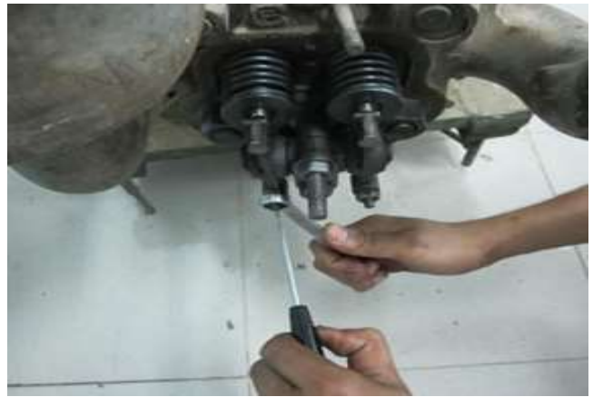
Hình 6.26. Vặn vít điều chỉnh
