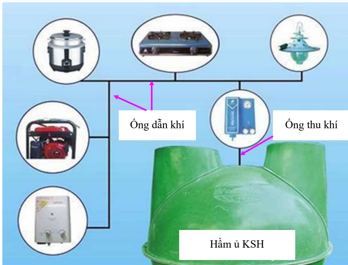
Hình 1.4.17. Hệ thống ống và dây dẫn khí
