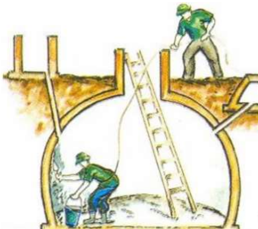
Hình 1.3.17. Xuống vệ sinh hầm phải đeo dây bảo hiểm và có người ở trên để hỗ trợ
