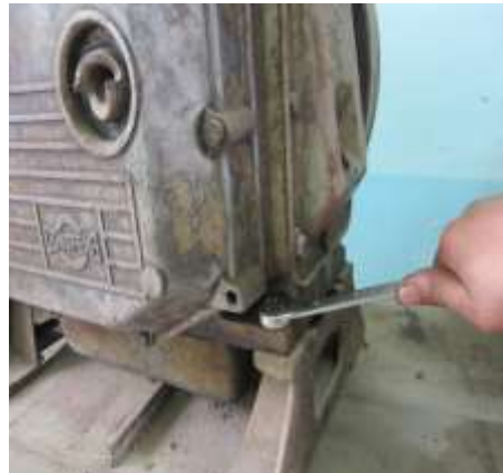
Hình 3.21. Siết bu lông bắt khung máy với động cơ
