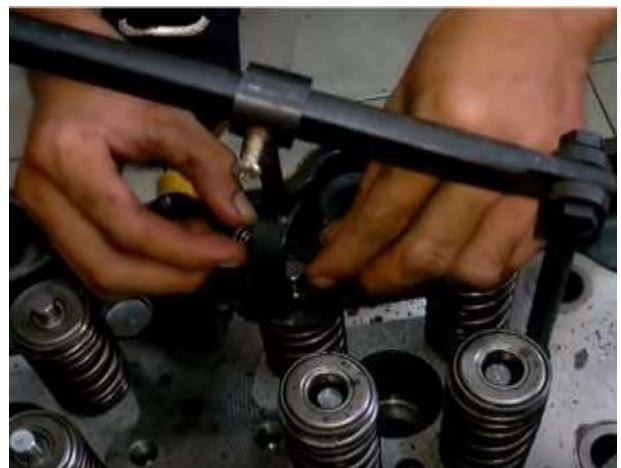
Hình 6.3. Tháo móng hãm
