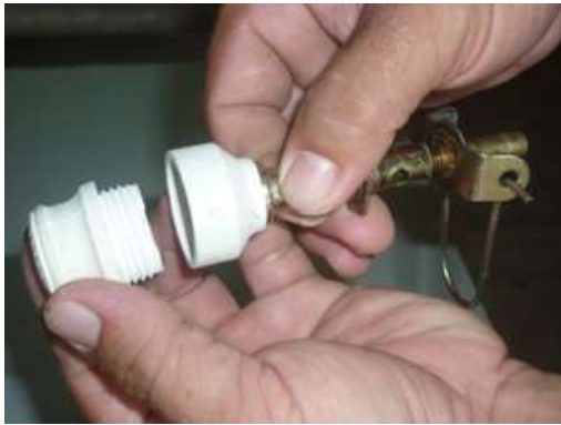
Hình 2.3.10. Lắp đầu đốt vào ống dẫn KSH
