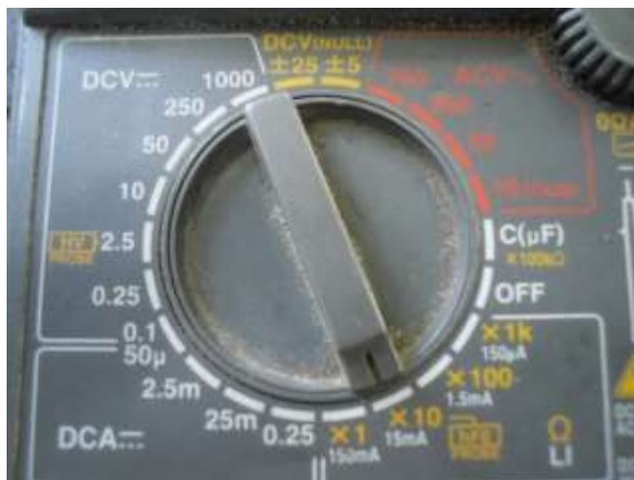
Hình 1.9.a. Chọn tầm đo \times 10
