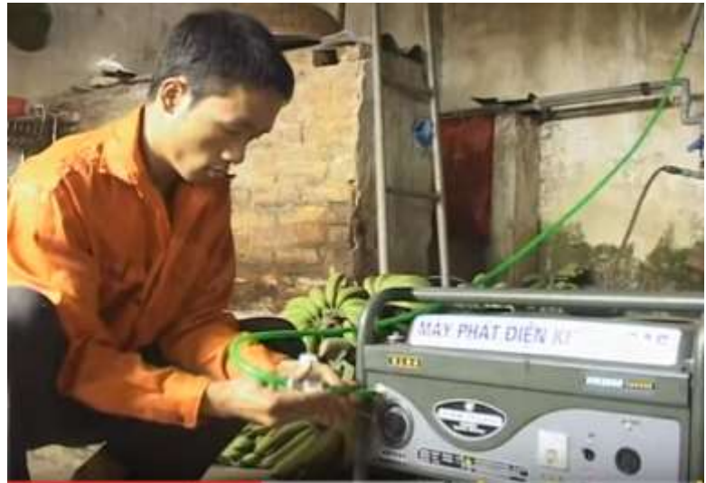
Hình 3.12. Lắp đường ống dẫn khí vào động cơ sơ cấp
