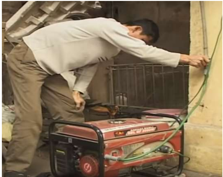
Hình 4.12. Điều chỉnh van cấp khí biogas
