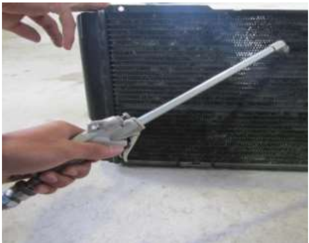
Hình 5.13. Dùng máy rửa áp suất cao xịt vào các rãnh thoát khí
