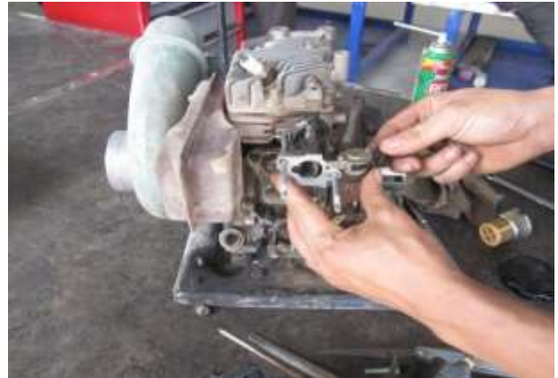
Hình 7.29. Lắp bộ chế hòa khí vào ống nạp
