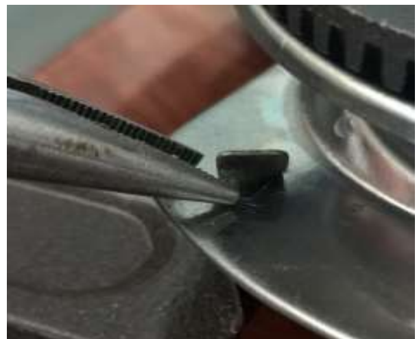
Hình 2.2.24. Gắn ống điều vào thân bếp
