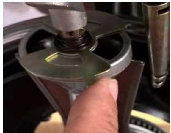
Hình 2.2.18. Lá chắn gió mở hoàn toàn
