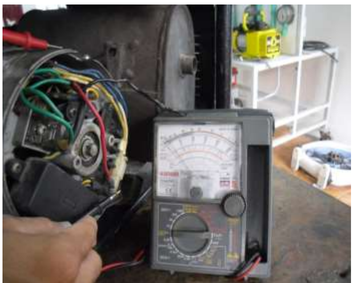
Hình 5.44.a. Đo cách điện cuộn dây 220V
