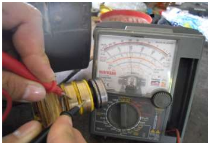
Hình 5.45. Đo thông mạch cuộn dây roto
