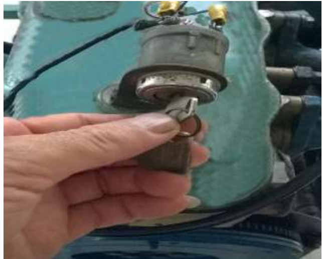
Hình 3.15. Vận khóa điện về vị trí OFF
