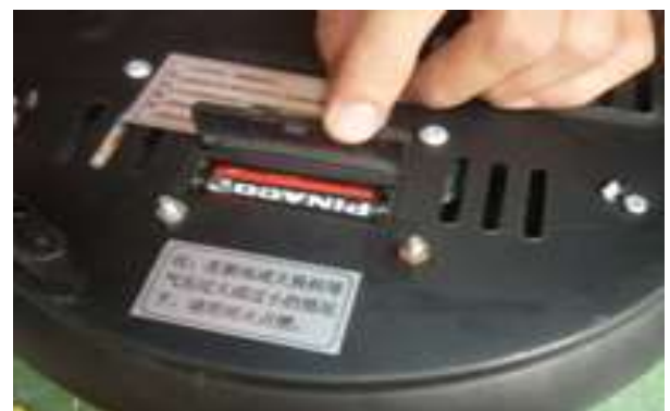
Hình 2.4.11. Lắp pin nguồn
