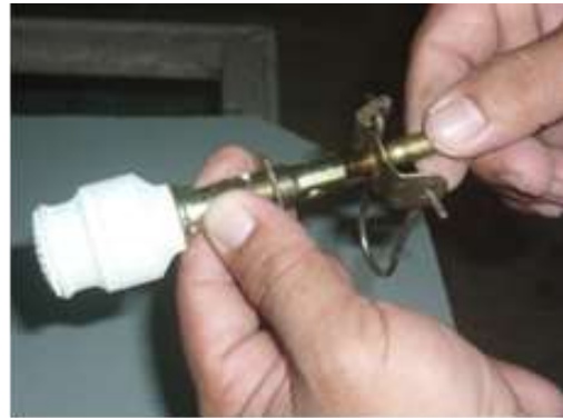
Hình 2.3.10. Lắp đầu đốt vào ống dẫn KSH
