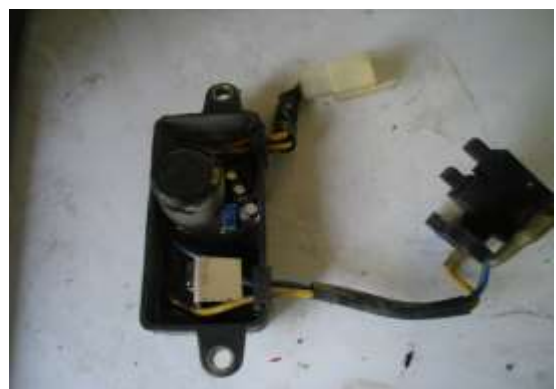
Hình 5.13.b. Tháo bộ tự động điều chỉnh dòng kích từ, giá đỡ và chổi than
