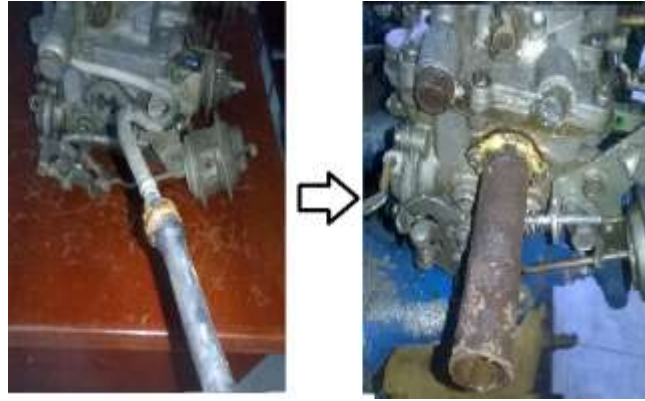
Hình 1.38. Tăng đường kính dẫn nhiên liệu
