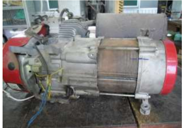
Hình 5.8.b. Tổ máy phát được lấy ra ngoài
