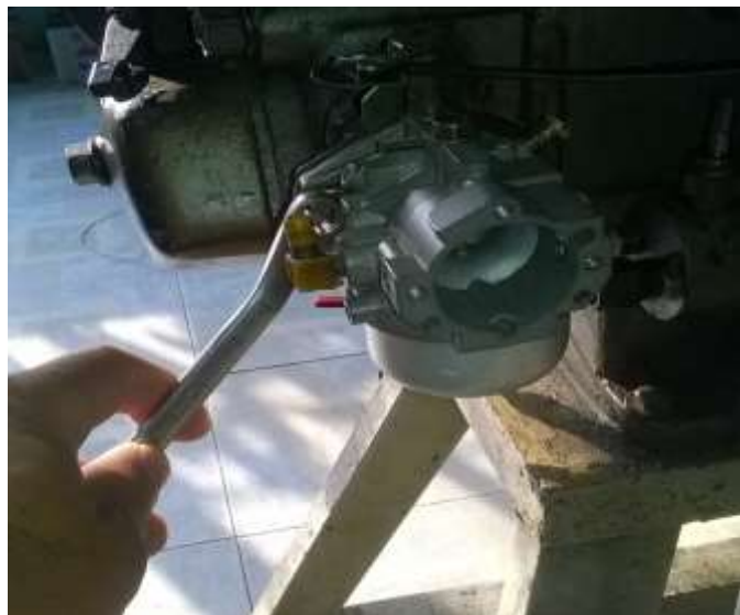
Hình 1.60. Lắp bộ chế hòa khí vào động cơ
