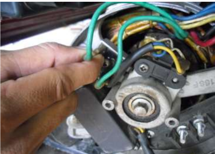
Hình 5.31. Lắp nguồn 12 VAC
