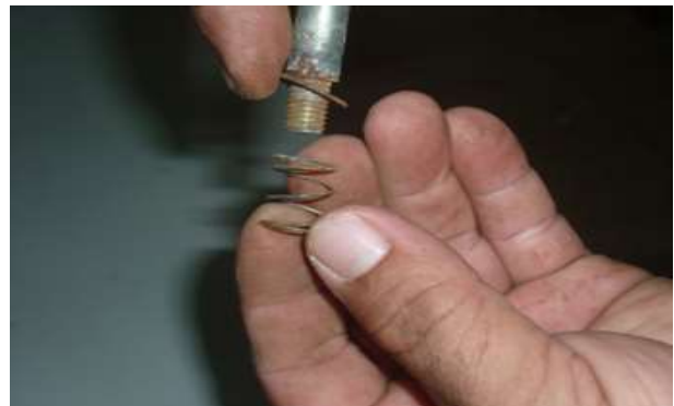
Hình 2.3.25. Lắp lò xo vào ống dẫn khí
