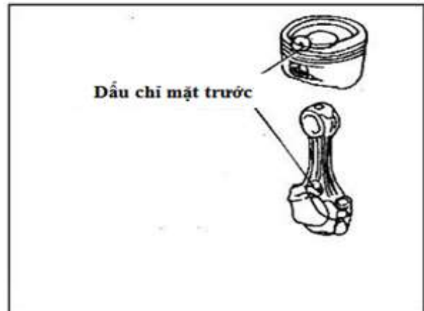
Hình 9.30. Lắp chốt pít tông
