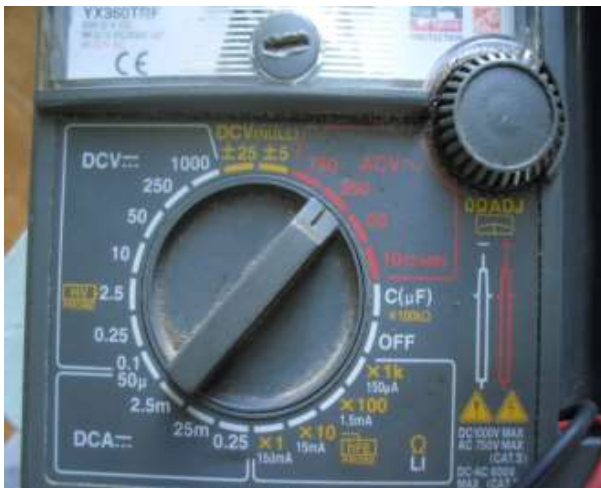
Hình 1.3.a. Chọn tầm đo 250 VAC
