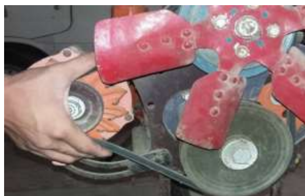
Hình 5.22. Lắp dây đai mới vào
