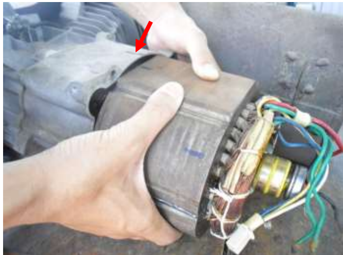
Hình 5.21. Lắp stator máy phát điện
