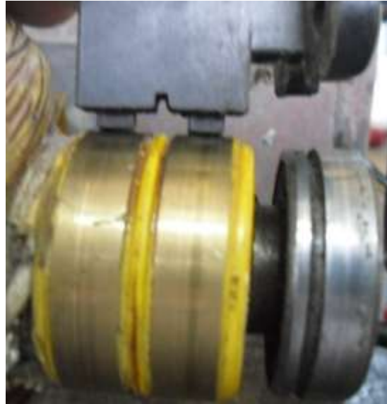
Hình 5.52. Quan sát bề mặt tiếp xúc của chổi than với cổ góp roto
