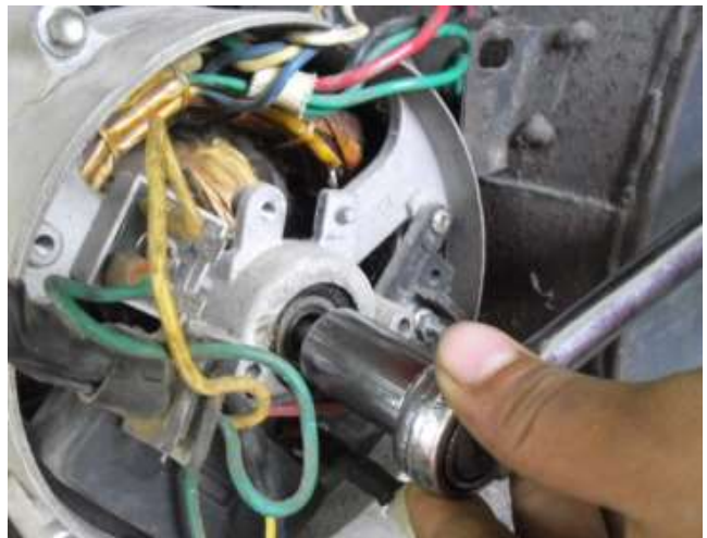
Hình 5.16. Tháo vỏ bảo vệ stato
