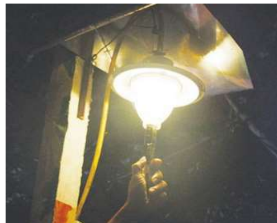
Hình 1.2.19. Bóng đèn được thắp sáng bằng KSH
