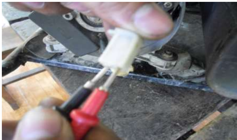
Hình 5.55. Đo nguồn AC cấp cho bộ tự động điều chỉnh dòng kích từ
