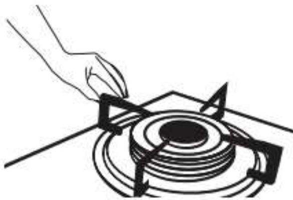
Hình 2.2.10. Lắp kiềng bếp
