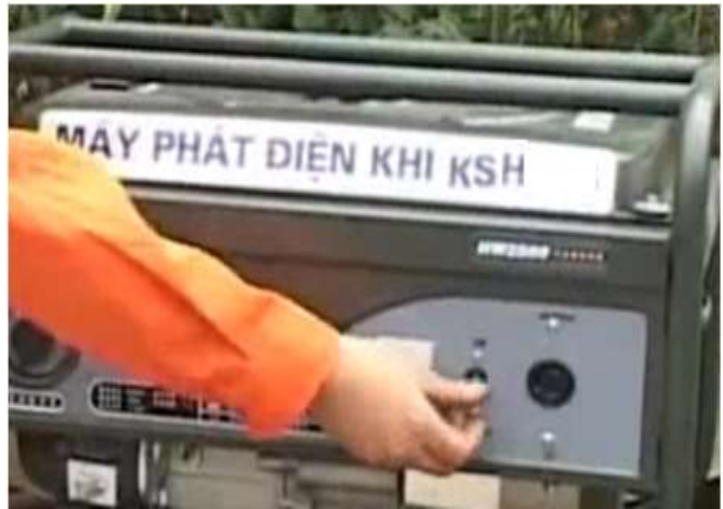
Hình 2.23. Bật cầu dao tải điện đầu ra về ON
