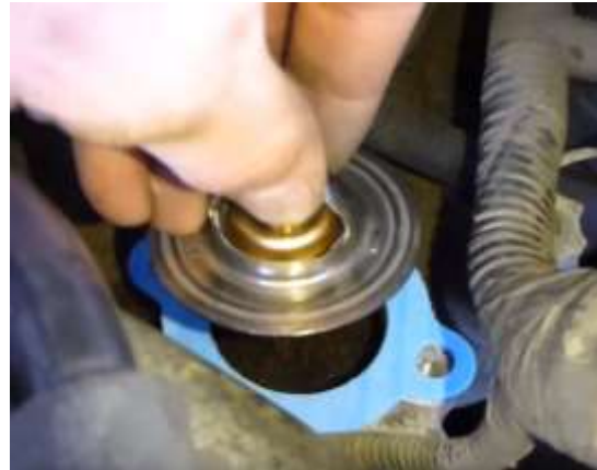
Hình 5.26. Lắp van hằng nhiệt
