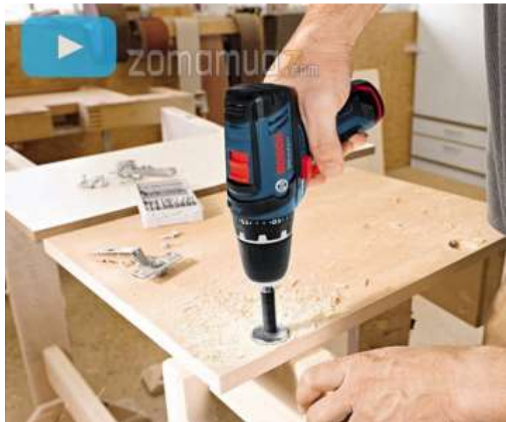
Hình 1.31. Chi tiết khoan phải được cố định chắc chắn trước khi thực hiện khoan
