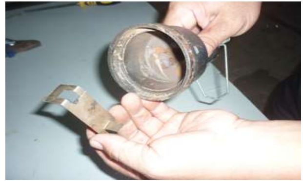
Hình 2.3.28. (a) Lắp giá đỡ mâm chia lửa
