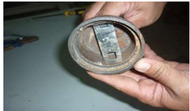
Hình 2.3.28b. Lắp giá đỡ mâm chia lửa
