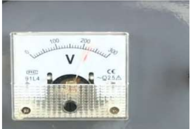
Hình 2.22. Đồng điện áp báo 220V
