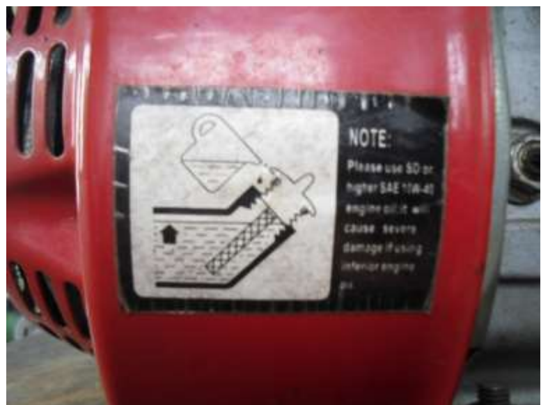
Hình 4.21. Nội dung hướng dẫn thay nhớt của nhà sản xuất ghi trên máy phát điện
