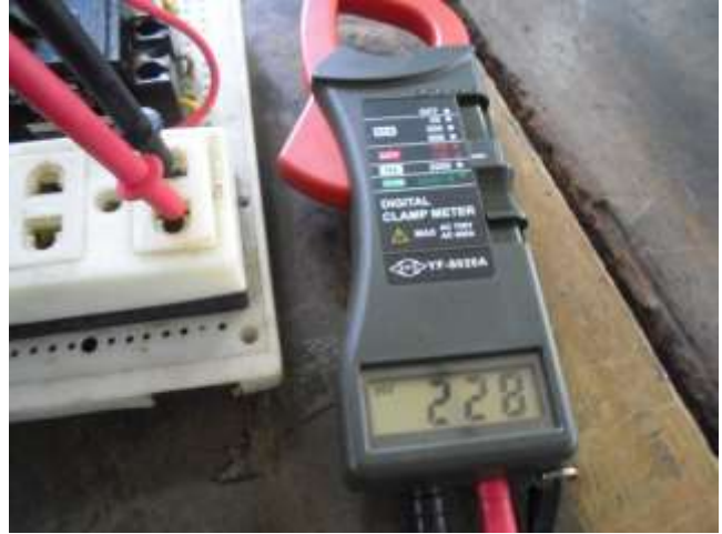
Hình 1.17. Đo điện áp xoay chiều
