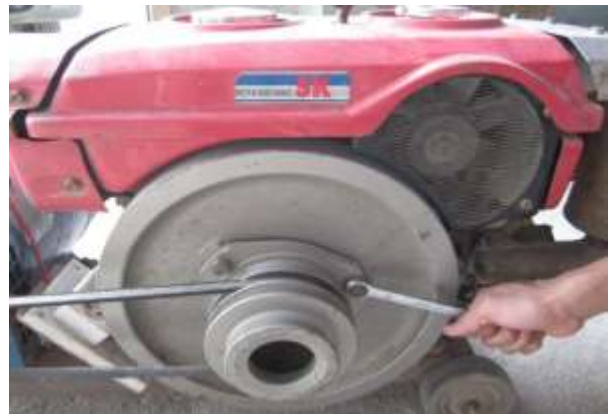
Hình 3.27. Siết chặt bu lông bắt pu ly với bánh đà
