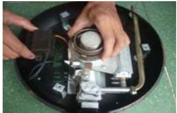
Hình 2.4.6. Lắp cụm bếp đun
