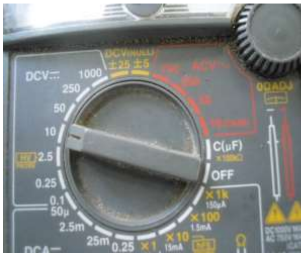
Hình 1.5.a. Chọn tầm đo 10 VDC
