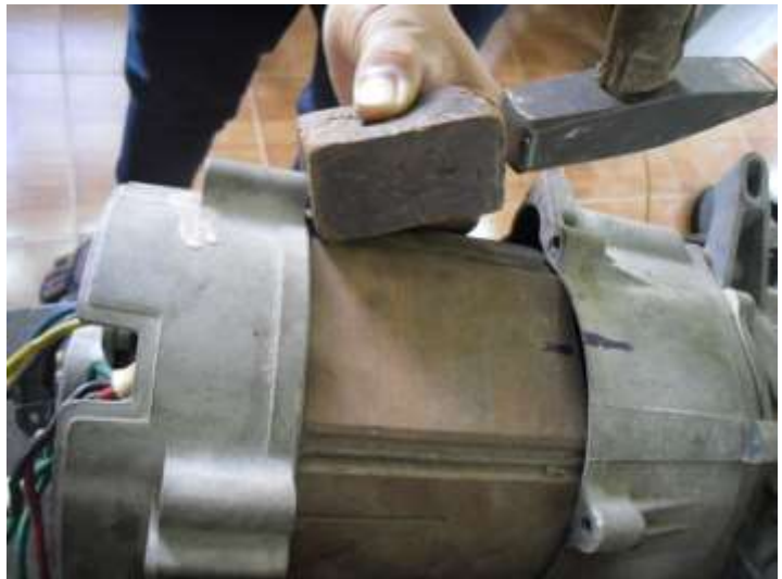
Hình 5.18. Tháo nắp trước máy phát điện
