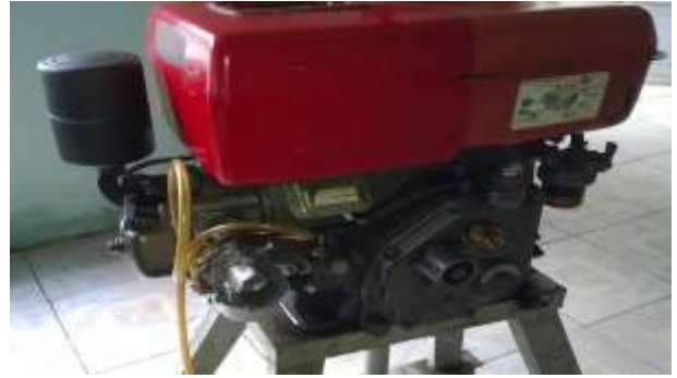
Hình 1.45. Động cơ điêzen được chuyển đổi thành động cơ KSH
