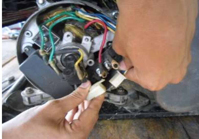
Hình 5.54. Tháo dây nguồn ngõ vào bộ tự động điều chỉnh dòng kích từ
