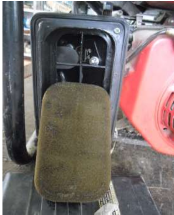
Hình 4.28. Hình dáng cấu tạo bên trong trong lọc gió của một tổ máy phát điện
