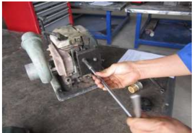
Hình 7.30. Siết chặt bu lông bắt bộ chế hòa khí và lọc xăng
