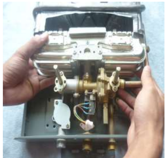
Hình 2.5.15. Lắp đầu đốt
