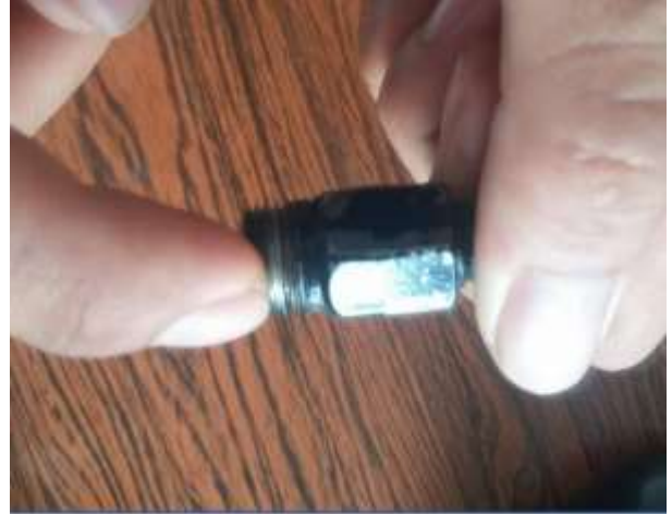
Hình 4.30. Thoa một lớp keo làm kín vào phần ren cảm biến
