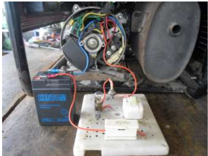
Hình 5.57. Nối mạch mời kích từ cho MFD
