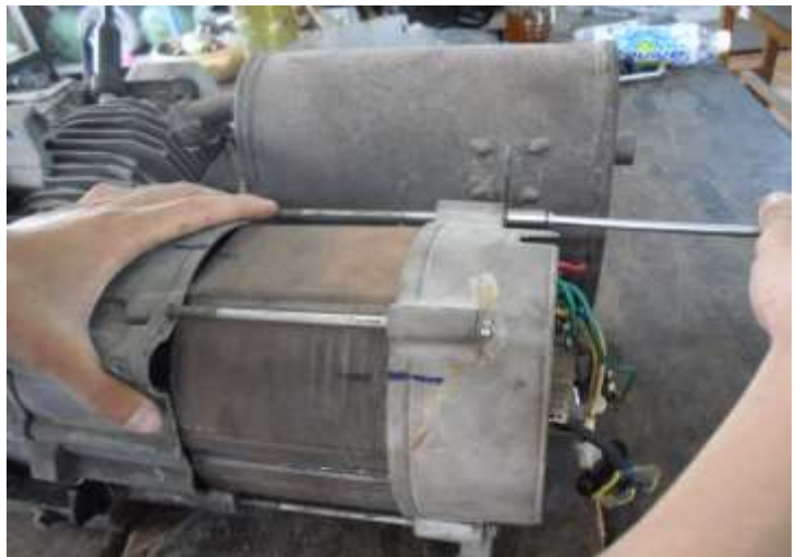
Hình 5.24. Lắp bu lông liên kết nắp với stato
