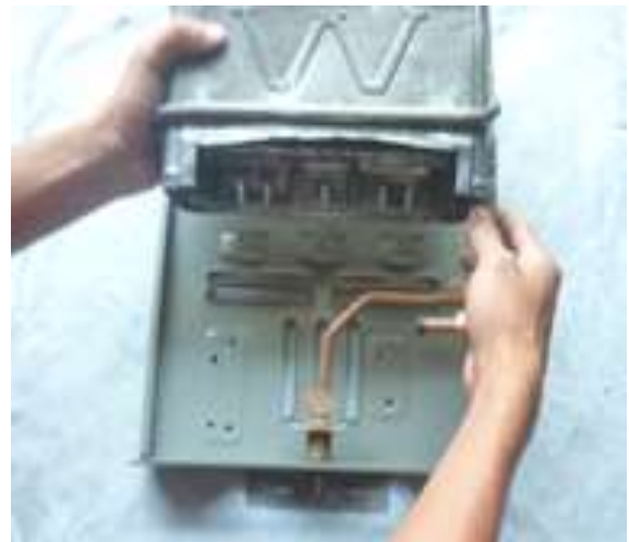
Hình 2.5.14. Lắp buồng đốt
