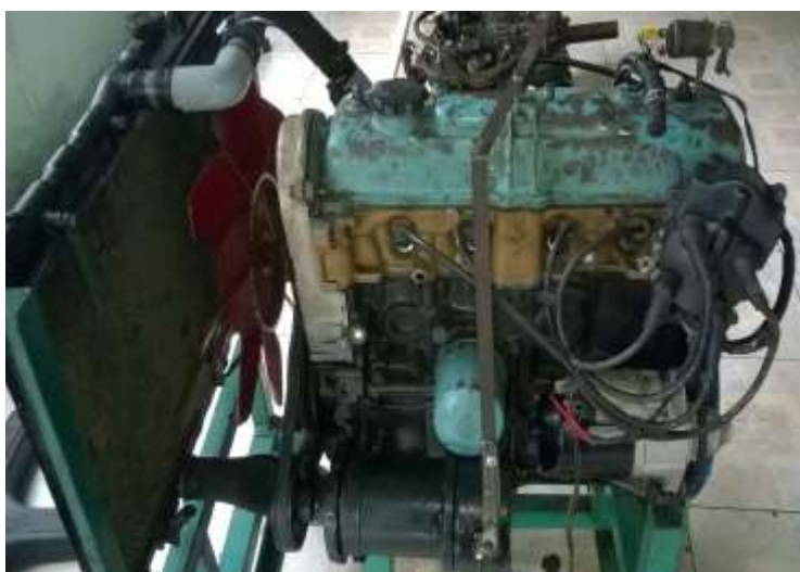
Hình 1.35. Động cơ xăng được chuyển đổi thành động cơ KSH
