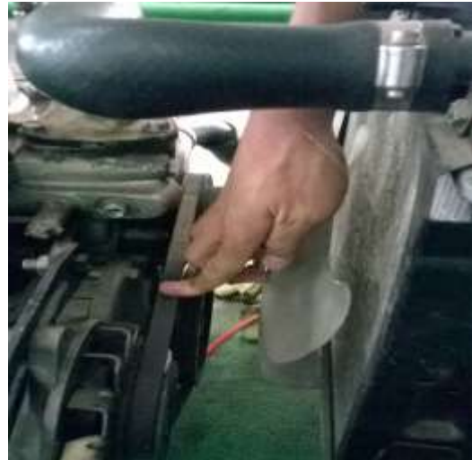
Hình 3.26. Kiểm tra lại độ căng dây đai
