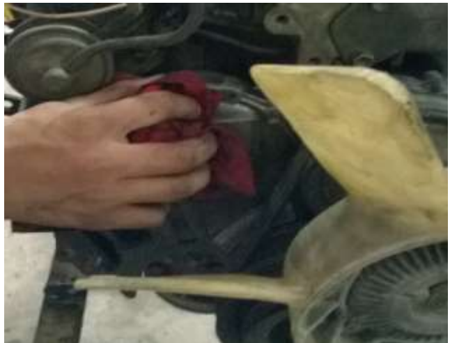
Hình 3.7. Làm sạch nắp hộp bánh răng
