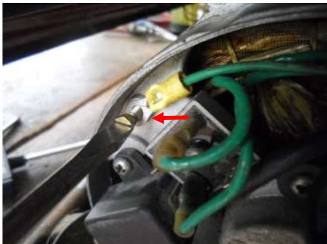
Hình 5.6. Tháo dây tiếp đất
