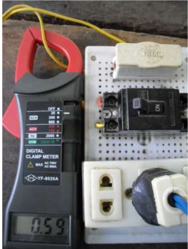
Hình 1.15. Dùng ampe kìm đo dòng điện
