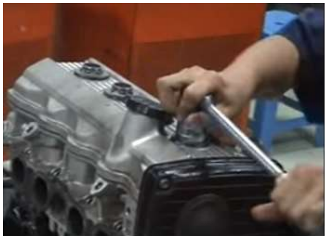
Hình 9.9. Tháo chụp nắp máy
