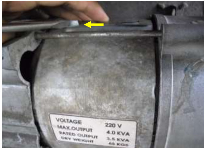
Hình 5.14. Tháo vỏ bảo vệ stato
