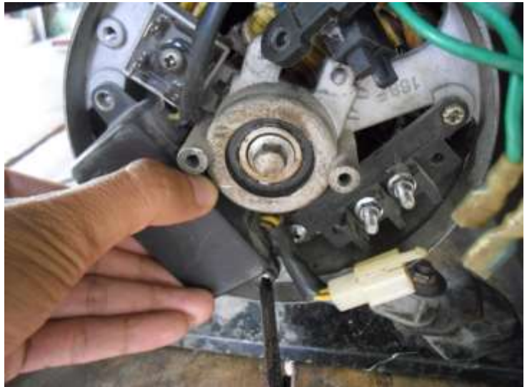
Hình 5.29. Lắp bộ tự động điều chỉnh dòng kích từ
