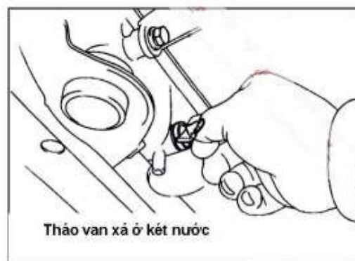
Hình 5.7. Tháo van xả ở ngăn phía dưới két nước
