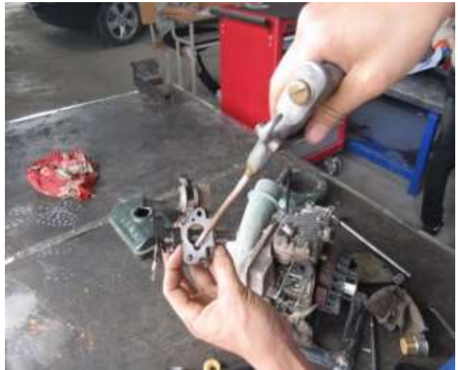
Hình 7.26. Dùng khí nén làm sạch các đường ống dẫn bên trong bộ chế hòa khí
