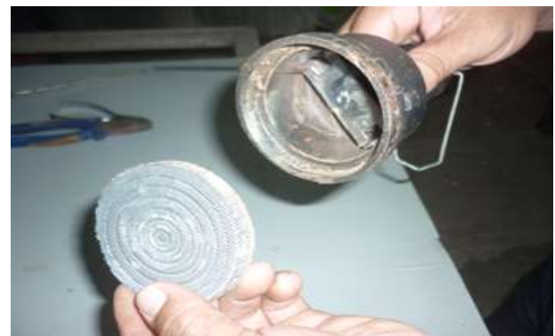
Hình 2.3.29a. Chuẩn bị lắp mâm chia lửa
