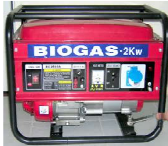
Hình 2.12. Siết bu lông liên kết động cơ vào giá đỡ máy
