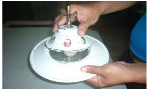
Hình 2.3.15. Lắp nắp trên vào chao đèn
