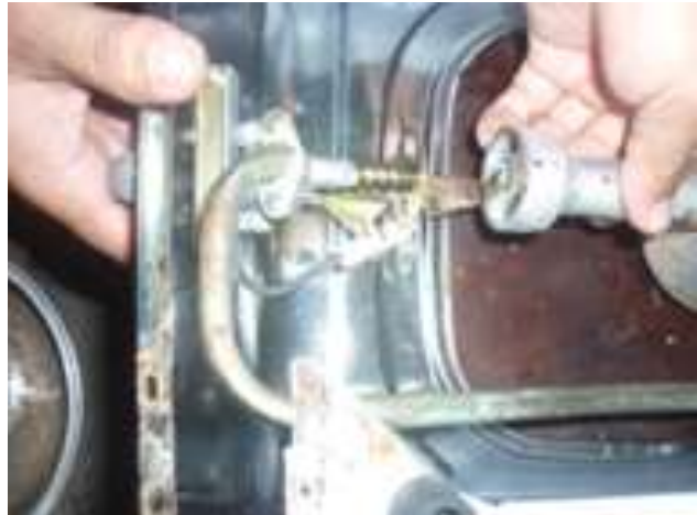
Hình 2.2.5. Lắp bộ phận dẫn khí
