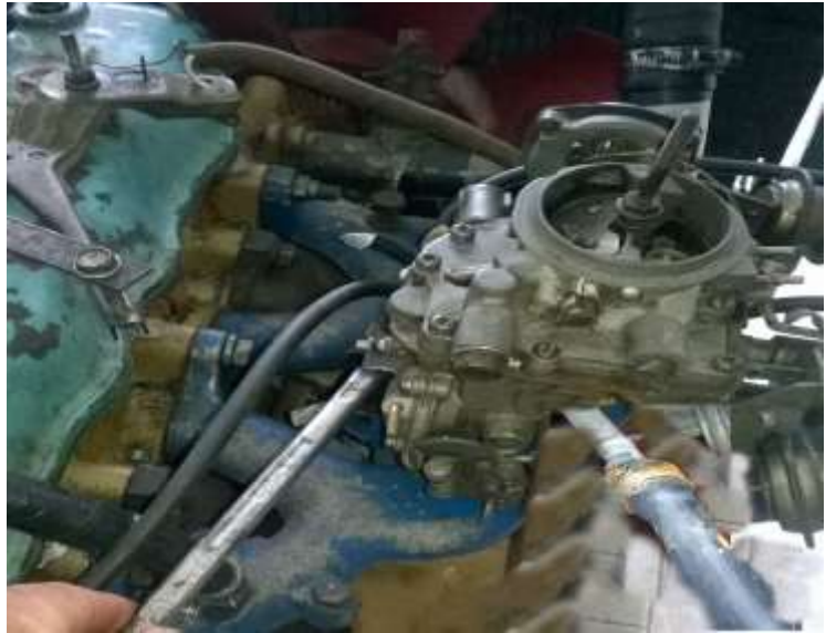
Hình 1.36. Tháo bộ chế hòa khí ra khỏi động cơ
