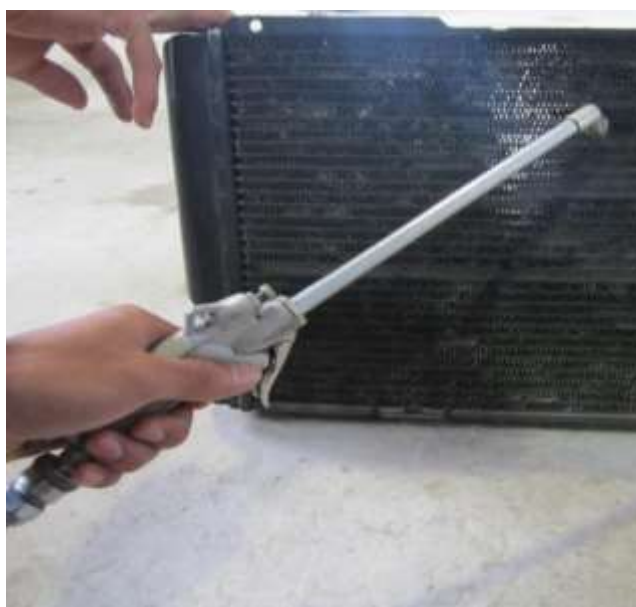
Hình 3.9. Làm sạch kết nước làm mát
