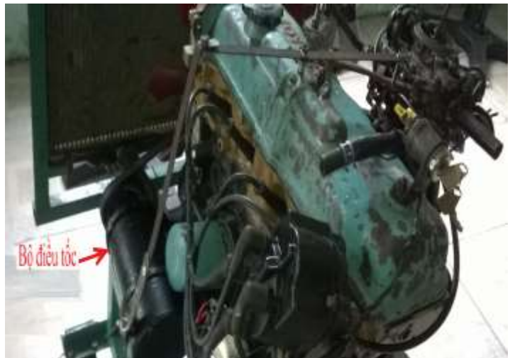
Hình 1.44. Lắp bộ điều tốc
