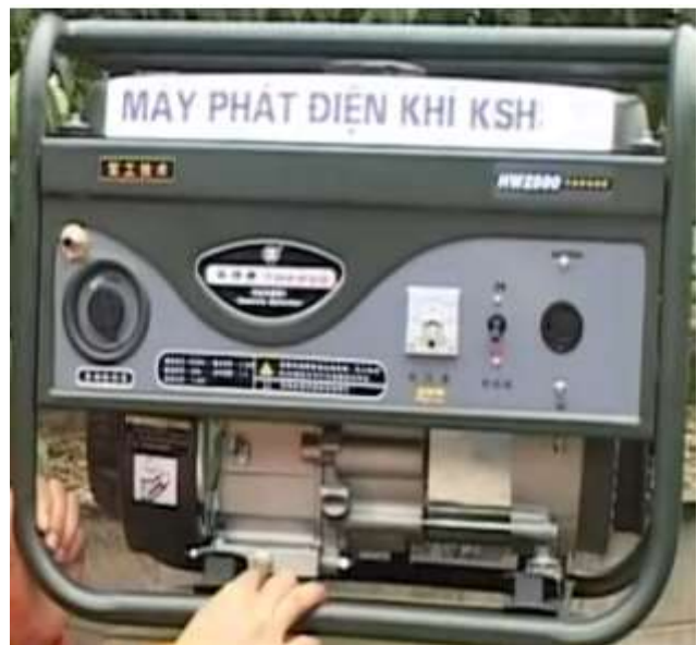
Hình 2.1. Máy phát điện sử dụng động cơ KSH
