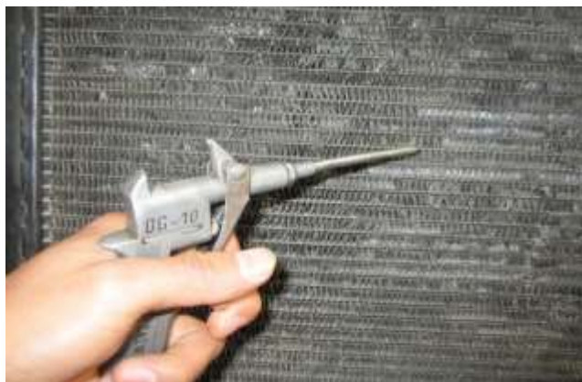
Hình 5.14. Dùng vòi xịt khí thổi vào các rãnh thoát khí
