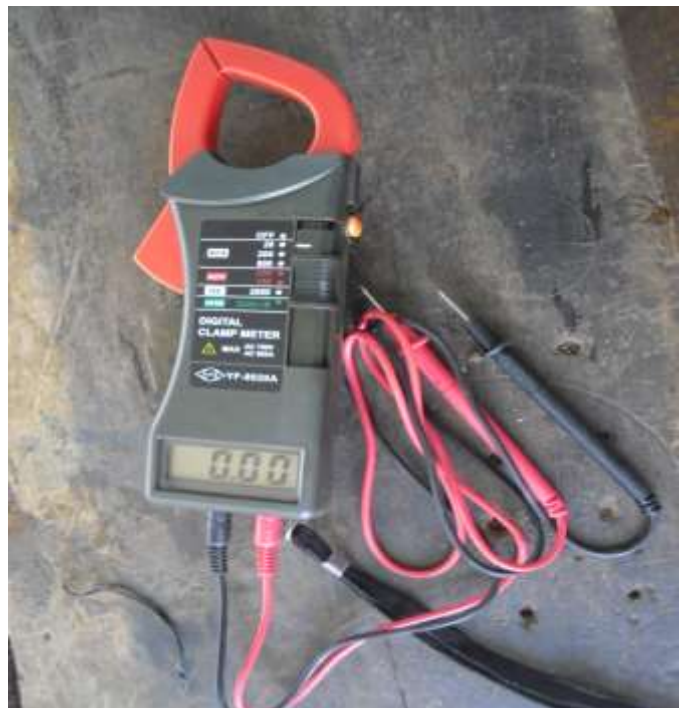
Hình 1.16. Gắn dây đo vào ampe kìm
