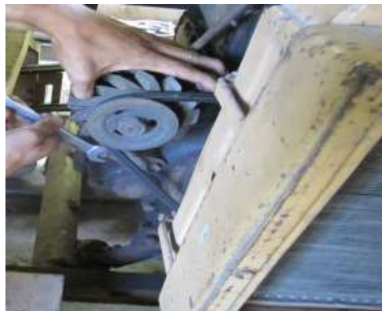
Hình 3.25. Điều chỉnh độ căng dây đai
