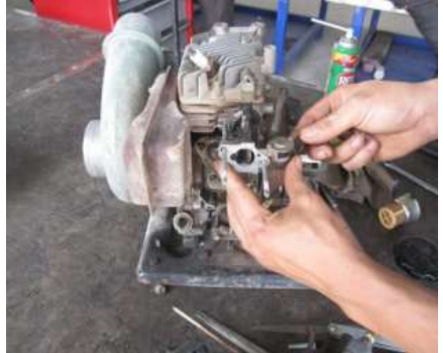
Hình 7.22. Rút bộ chế hòa khí ra khỏi ống nạp
