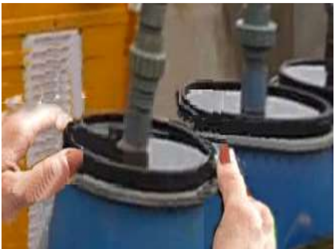
Hình 7.18. Lắp nắp bình lọc
