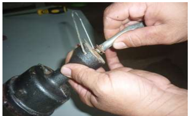
Hình 2.3.27. Lắp đặt đầu đốt
