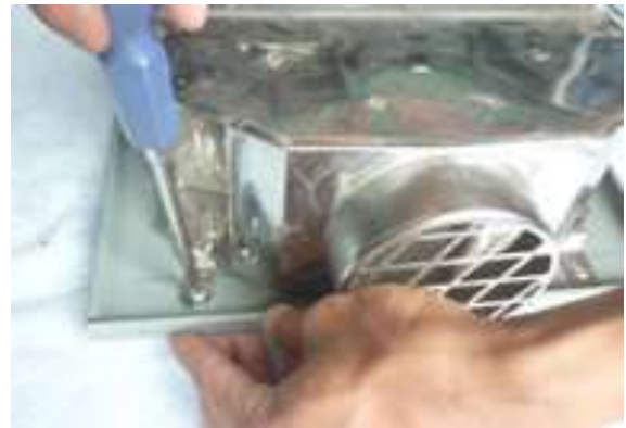
Hình 2.5.30. Cố định nắp thu khí thải vào đế của thiết bị
