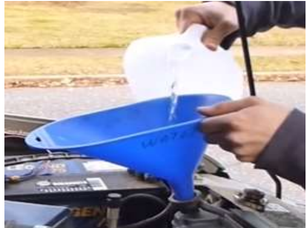
Hình 5.9. Đổ nước làm mát
