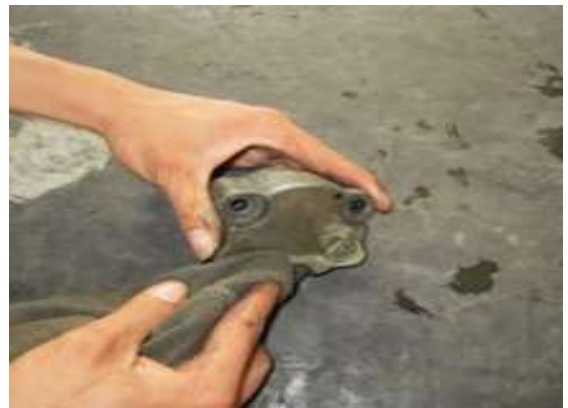
Hình 4.25. Dùng dẻ khô lau sạch bơm
