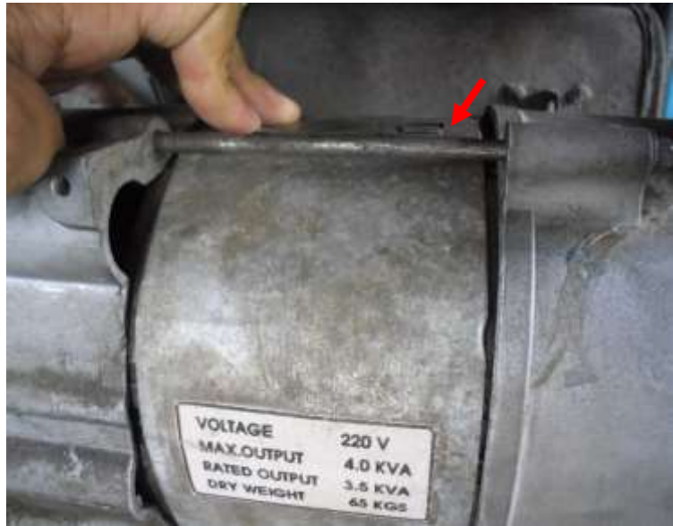
Hình 5.41. Lắp vỏ bảo vệ stator
