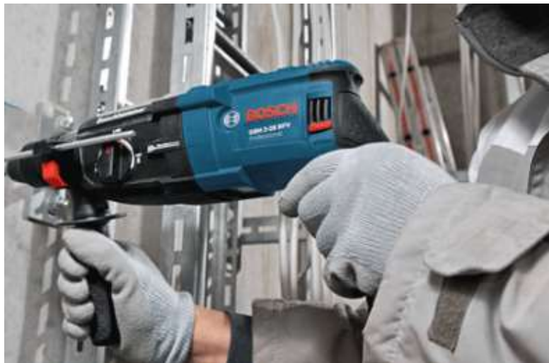
Hình 1.33. Sử dụng bảo hộ lao động đầy đủ, gọn gàng khi khoan
