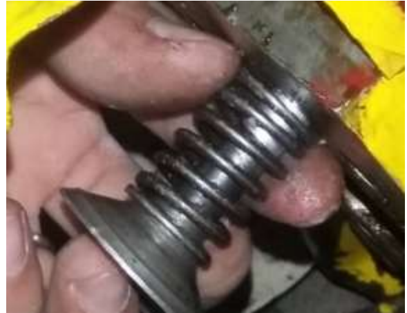
Hình 6.9. Lắp xu páp vào lò xo cần rà vào ổ đặt
