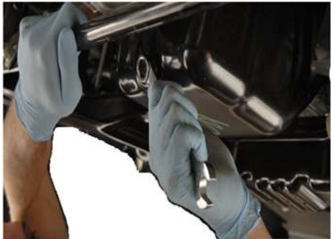
Hình 9.8. Xả nhớt và nước làm mát
