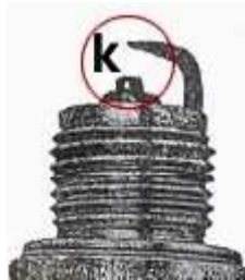
Hình 4.26.a. Chấu mòn, khe hở K rộng
