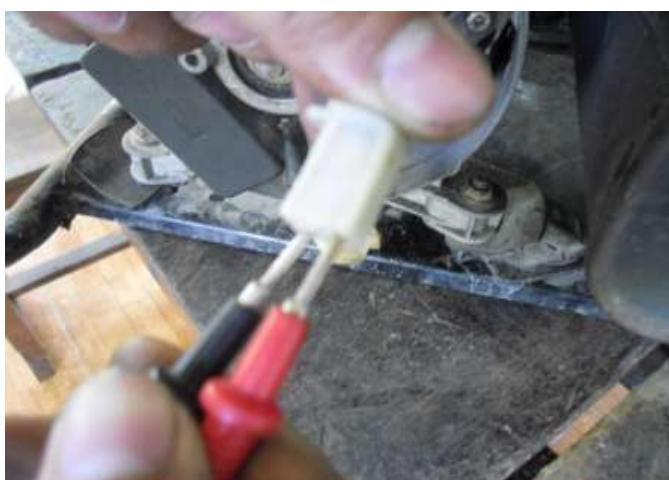
Hình 5.62. Đo điện áp AC, tín hiệu hồi tiếp điện áp ngõ vào bộ tự động điều chỉnh dòng kích từ
