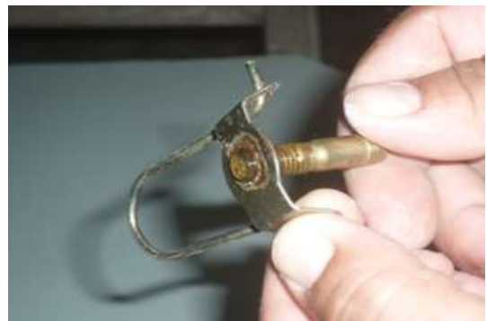
Hình 2.3.9. Lắp quai treo đèn vào ống dẫn khí có vòi phun
