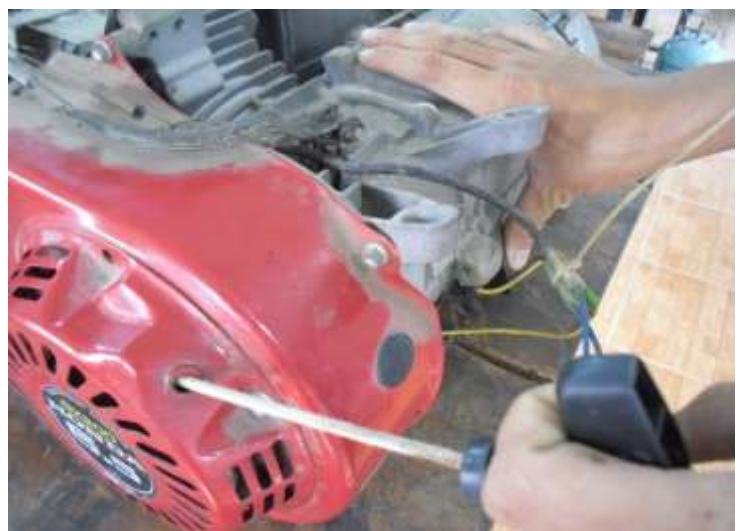
Hình 5.28. Kiểm tra độ quay trơn của roto
