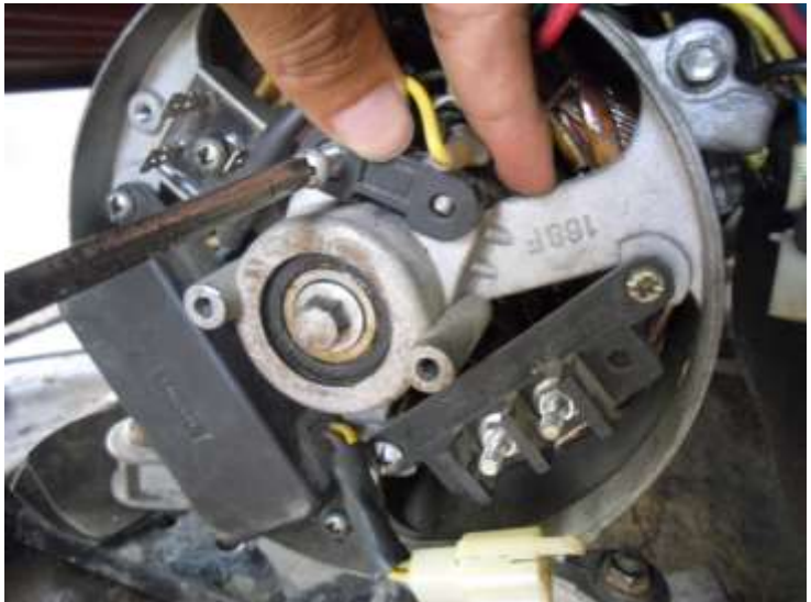
Hình 5.30. Lắp giá đỡ, chổi than
