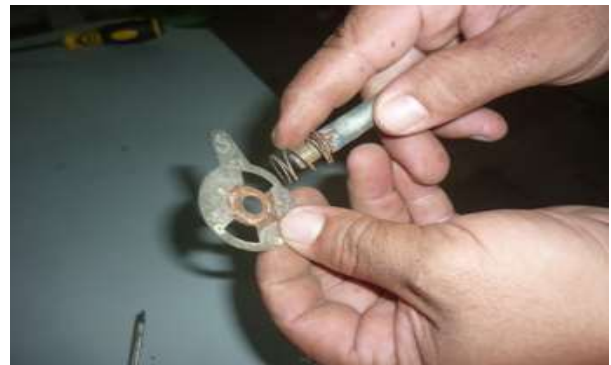
Hình 2.3.26. Lắp lá chắn gió
