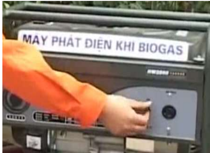
Hình 3.28. Đóng CB tổ máy phát điện
