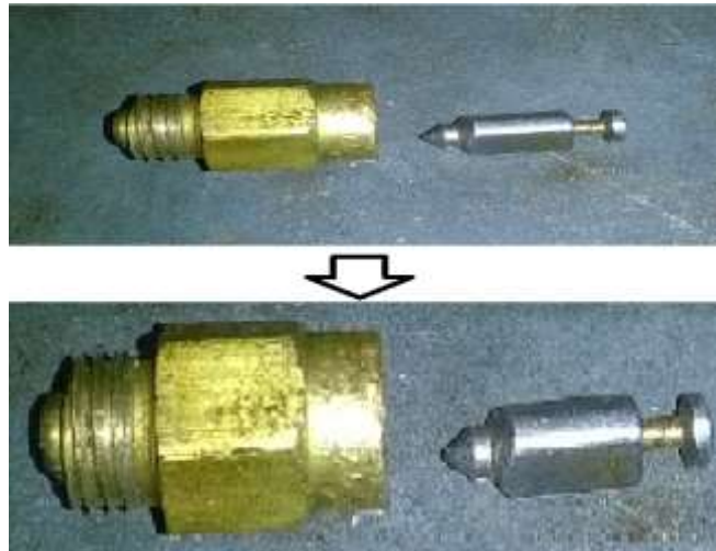
Hình 1.54.a. Van kim thay mới có kích thước lớn hơn
