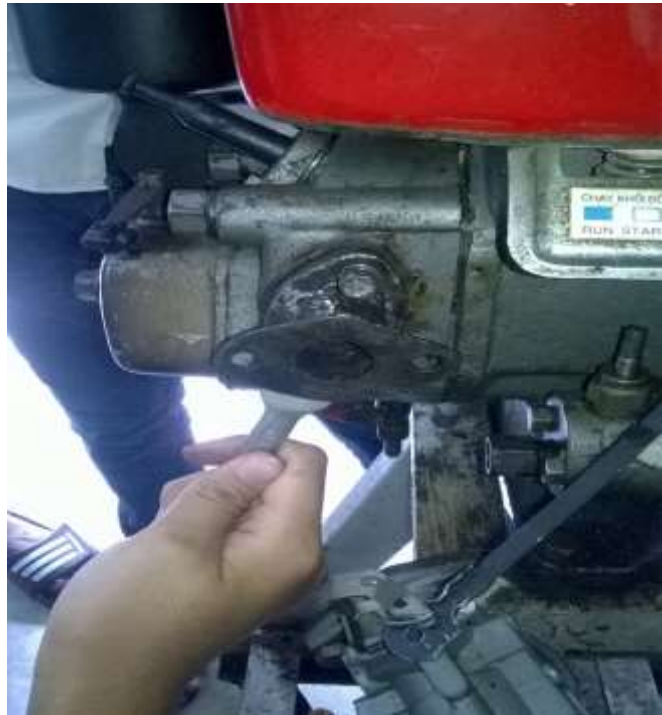
Hình 1.59. Lắp cụm ống hút vào động cơ
