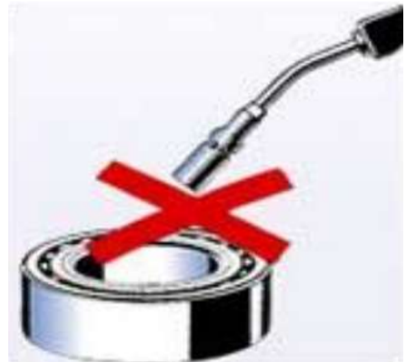
Hình 5.67. Không được gia nhiệt trực tiếp vào ổ bi
