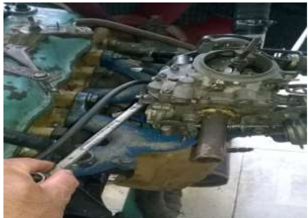
Hình 1.41. Động cơ xăng được chuyển đổi thành động cơ KSH
