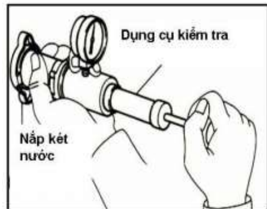
Hình. 5.27. Kiểm tra độ kín của hệ thống
