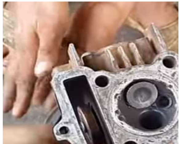
Hình 6.10. Ấn và xoay khi xu páp tiếp xúc với ổ đặt
