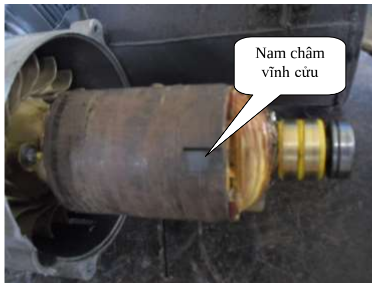
Hình 5.53. Roto máy phát điện có nam châm vĩnh cửu
