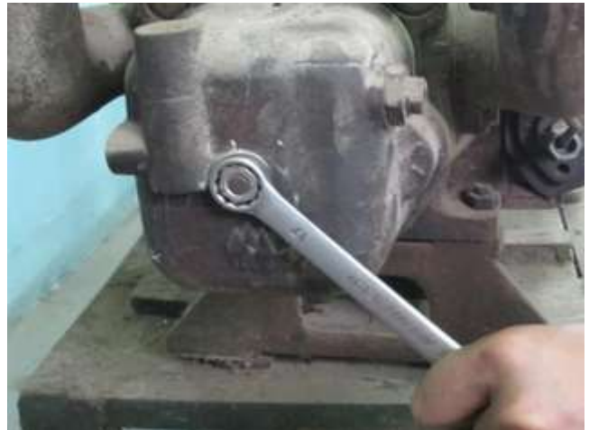
Hình 6.27. Lắp nắp đẩy giàn đòn gánh.
