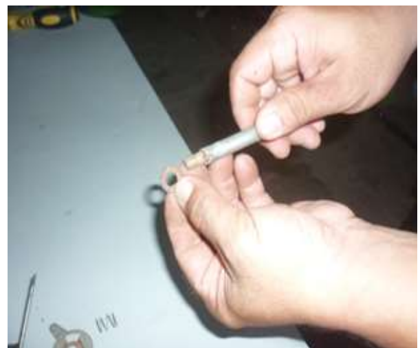
Hình 2.3.23. Bôi dầu nhờn đầu ống dẫn KSH
