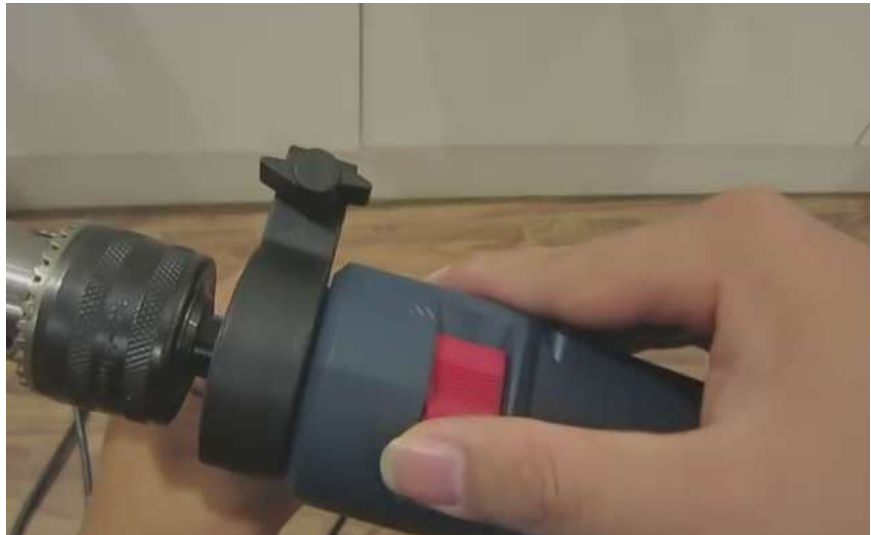
Hình 1.30. Kiểm tra nút chuyển chế độ khoan
