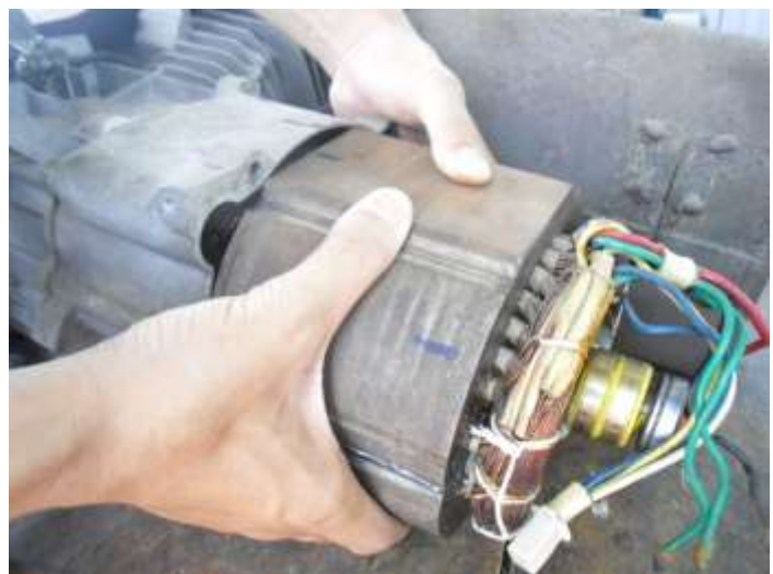
Hình 5.19. Tháo stato máy phát điện
