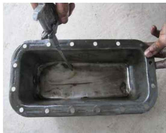
Hình 4.17. Thổi sạch các các te bằng khí nén
