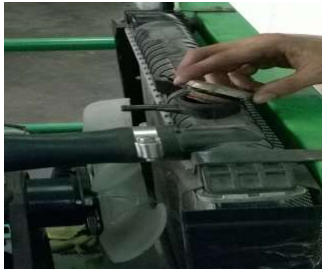
Hình 3.18. Mở nắp két nước làm mát
