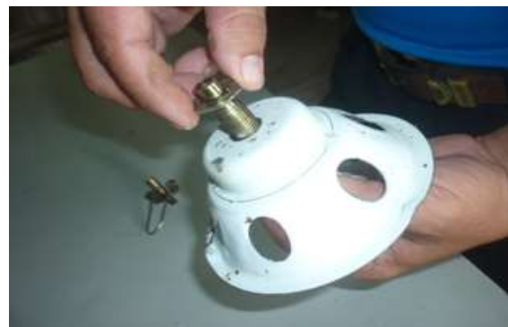
Hình 2.3.12.(b) Lắp cuối đốt vào nắp trên
