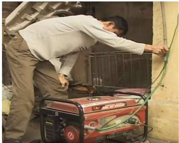
Hình 3.20. Đóng van cấp khí biogas
