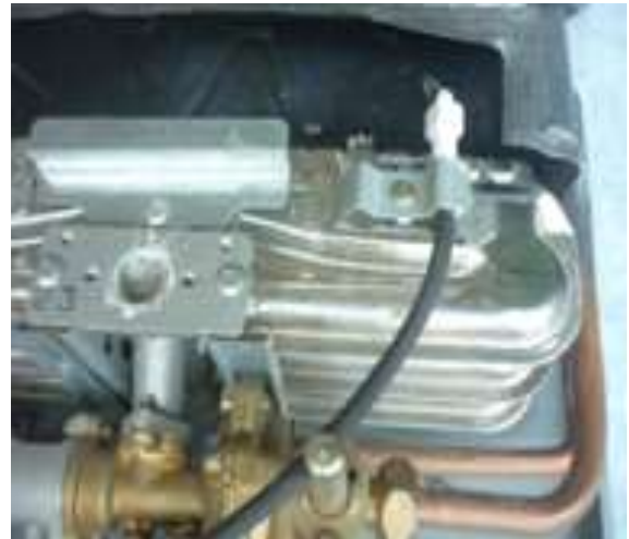
Hình 2.5.24. Vít lửa thứ 3 sau khi lắp
