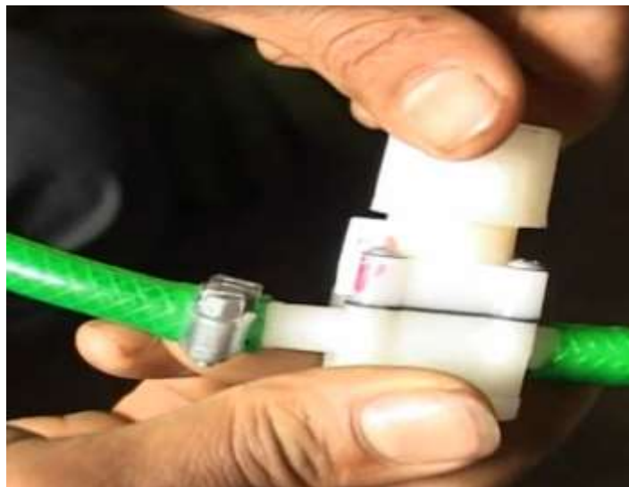
Hình 2.24. Đóng van trước khi tắt máy
