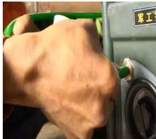
Hình 2.14. Lắp ống dẫn gas vào bộ chế hòa khí
