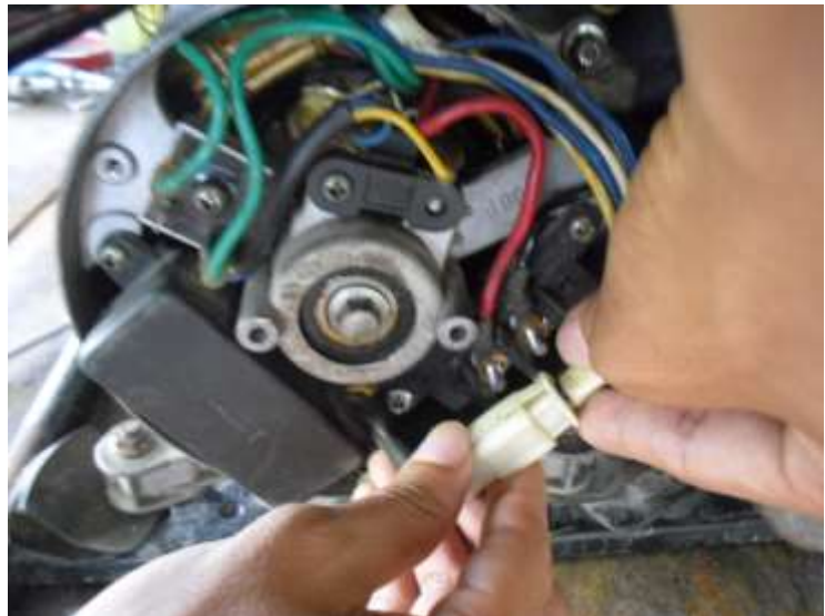
Hình 5.33. Lắp dây ngõ vào bộ tự động điều chỉnh dòng kích từ
