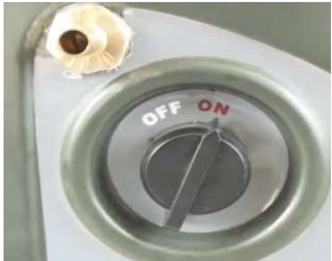
Hình 2.15. Mở công tắc máy về vị trí ON
