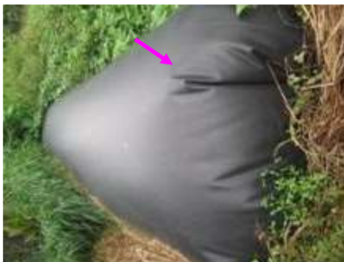
Hình 1.3.7. Nếp gấp khi túi ủ bị gập
