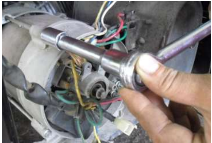
Hình 5.17. Tháo ốc cố định stato với nắp
