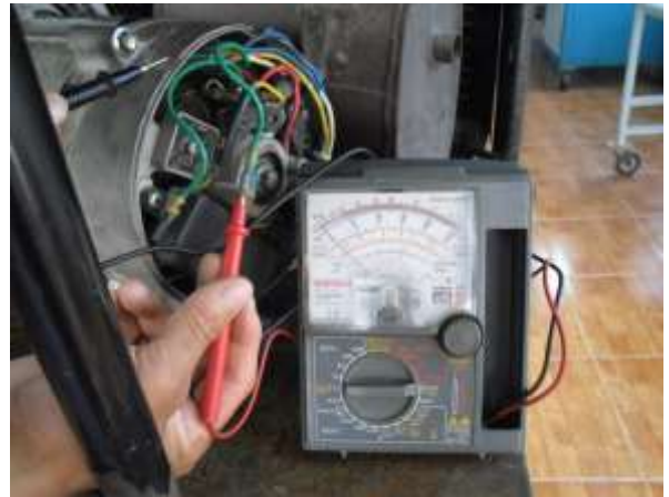
Hình 5.44.c. Đo cách điện cuộn dây 12V
