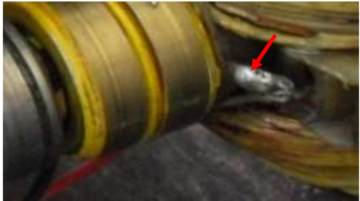
Hình 5.46. Mối nối giữa đầu ra của dây quấn roto với vành trượt
