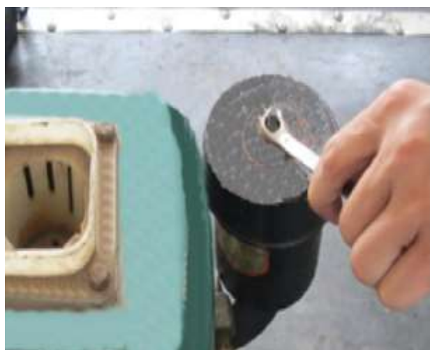
Hình 7.2. Tháo nắp đáy bình lọc
