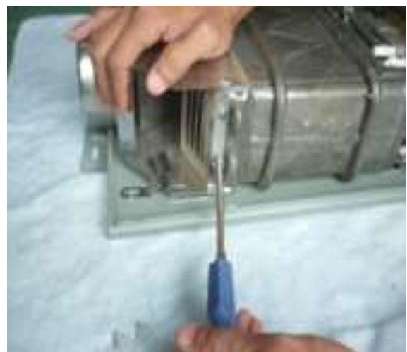
Hình 2.5.29. Cố định nắp thu khí thải
