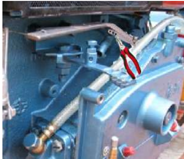
Hình 7.32. Gấp lò xo bộ điều tốc ra
