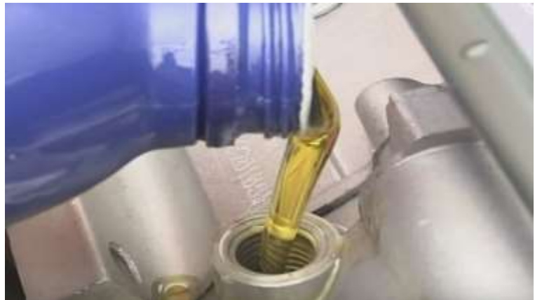
Hình 4.22. Châm nhót vào động cơ sơ cấp của MFD
