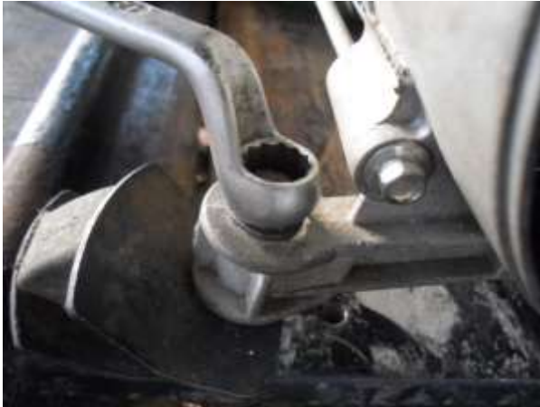
Hình 5.8.a. Tháo ốc cố định tổ máy phát điện với giá đỡ
