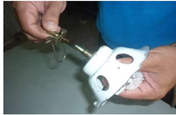
Hình 2.3.13. Lắp quai treo đèn
