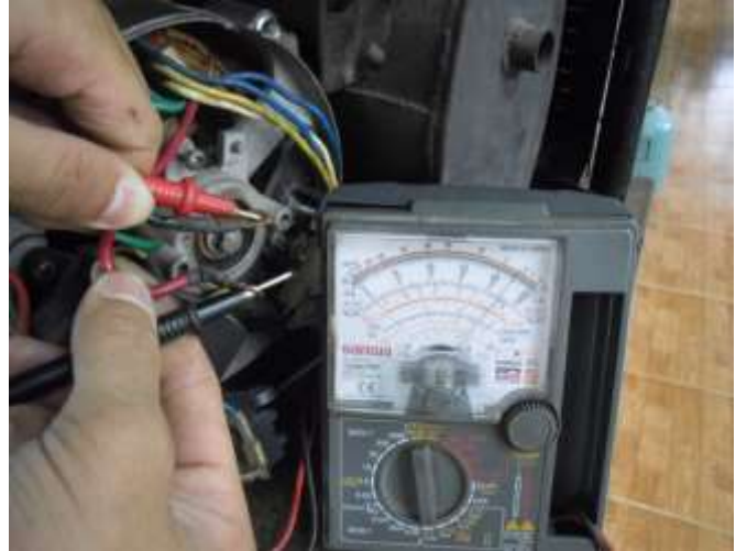
Hình 5.42.a. Đo thông mạch cuộn dây 220 V
