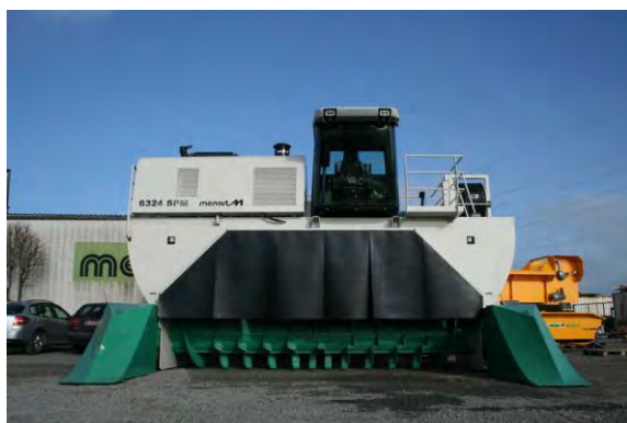
Hình 3.5.3. Mô hình máy đánh toi
