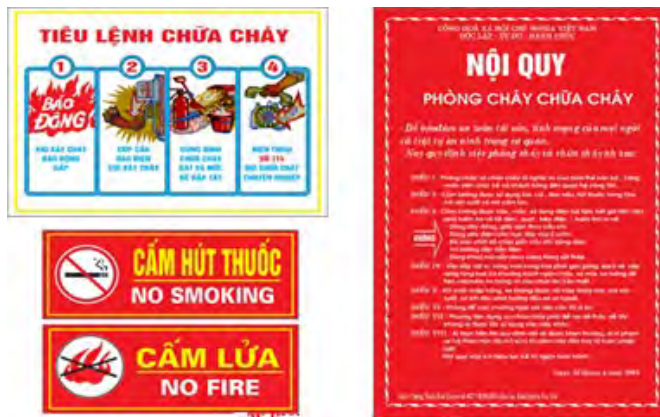
Hình 1.2.13. Bảng nội quy, biển cấm và tiêu lệnh chữa cháy
