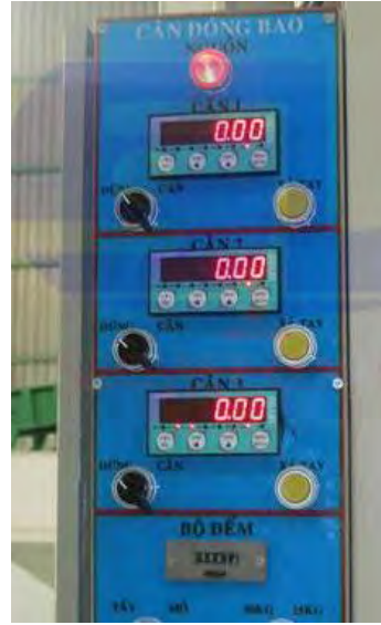
Hình 3.9.14. Hệ thống điều khiển cân đóng bao
