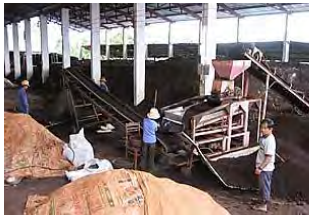
Hình 3.3.10. Trộn nguyên phụ liệu bằng máy trộn và hệ thống băng tải
