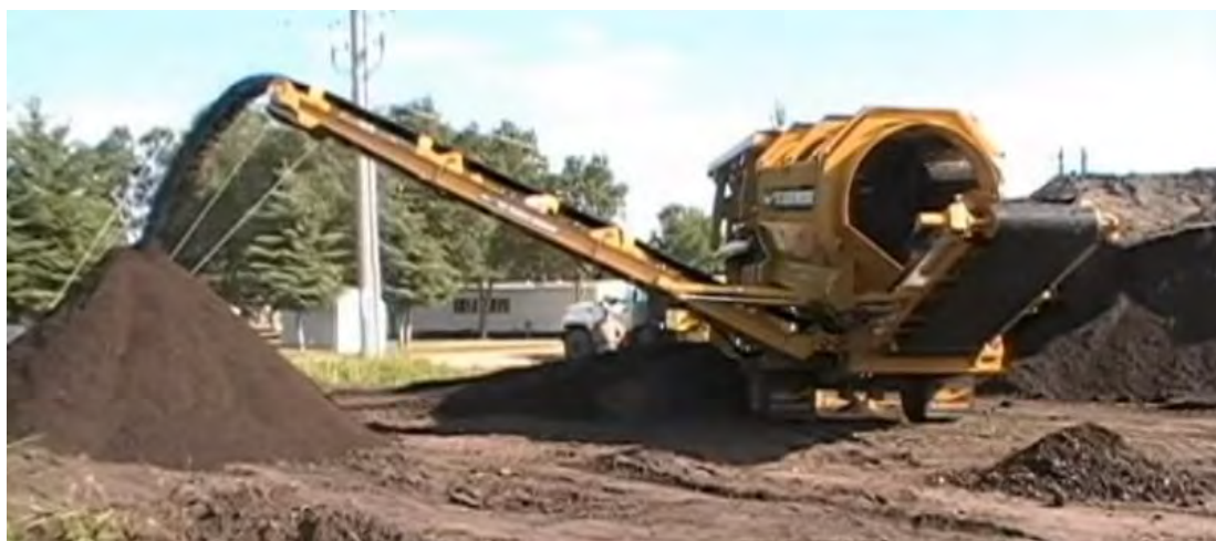
Hình 3.5.11. Hoạt động của máy sàng phân loại dạng thùng quay
