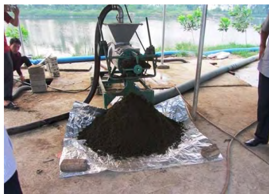
Hình 2.2.11. Tách nước khối phân trâu, bò bằng máy ép
