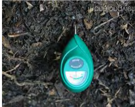
Hình 3.2.42. Kiểm tra độ ẩm phân trâu, bò bằng máy
