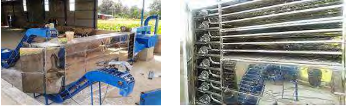
Hình 2.3.16. Máy sấy băng tải nhiều tầng
