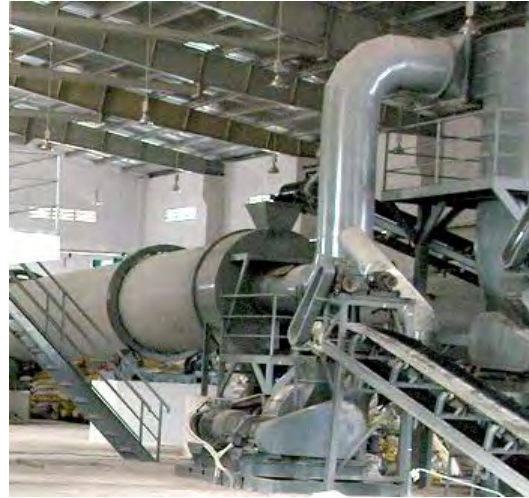
Hình 3.6.9. Mô hình hoạt động của thiết bị sấy thùng quay
