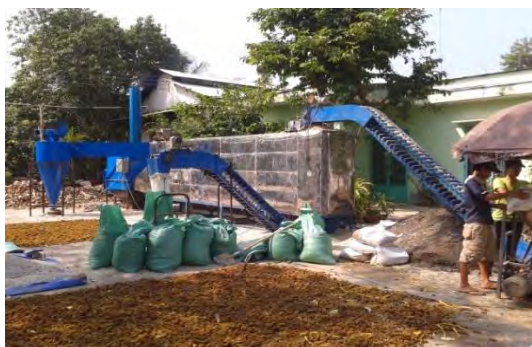
Hình 3.2.55. Đóng nguyên phụ liệu vào bao bằng máy
