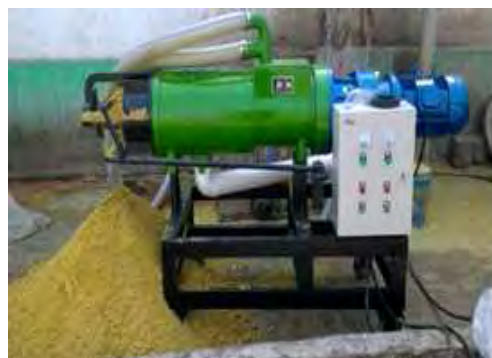
Hình 2.1.16. Máy ép tách nước phân trâu, bò
