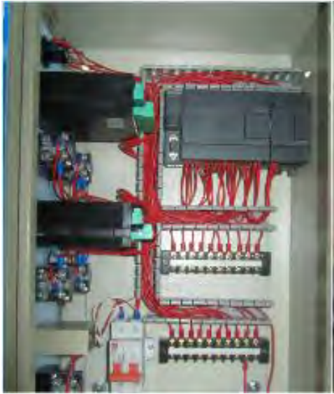
Hình 3.9.14. Hệ thống điều khiển cân đóng bao
