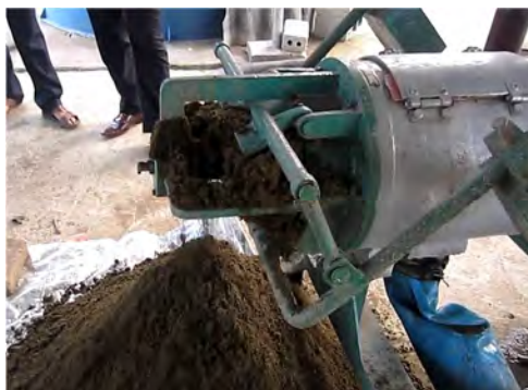
Hình 2.1.16. Máy ép tách nước phân trâu, bò
