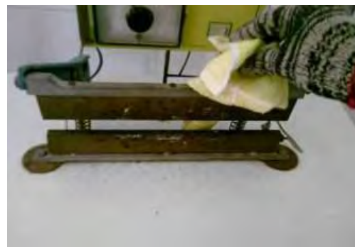
Hình 3.2.29. Vệ sinh máy bằng cách lau khô
