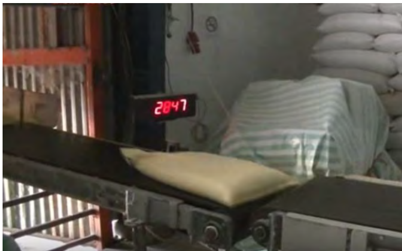
Hình 3.9.16. Hệ thống đếm bao sản phẩm trên băng tải
