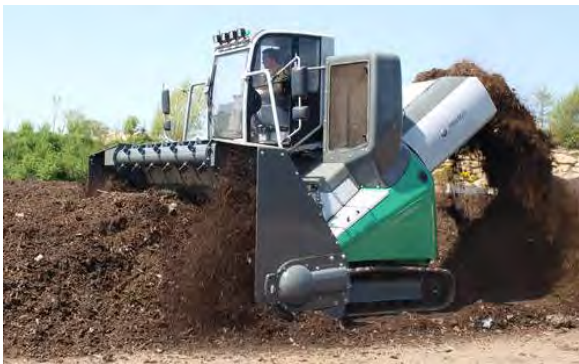
Hình 3.5.9. Hoạt động của máy đánh tơi di động
