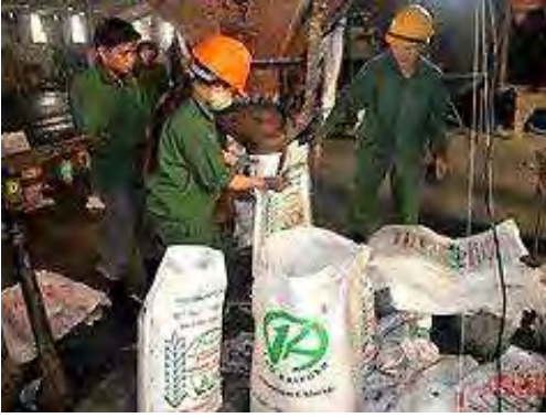
Hình 2.3.38. Đóng bã bùn mía vào bao bằng máy
