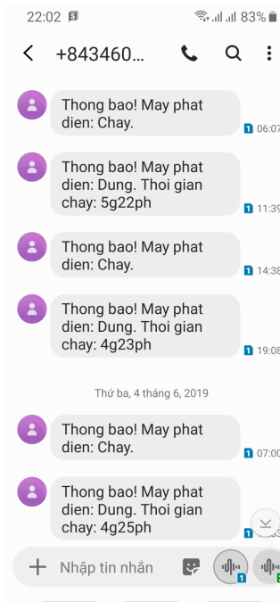
Hình 3. Thử nghiệm hệ thống nhắn tin tự động về thời gian chạy máy và thay thế vỏ lọc bằng thép nhập khẩu bằng vật liệu composite
