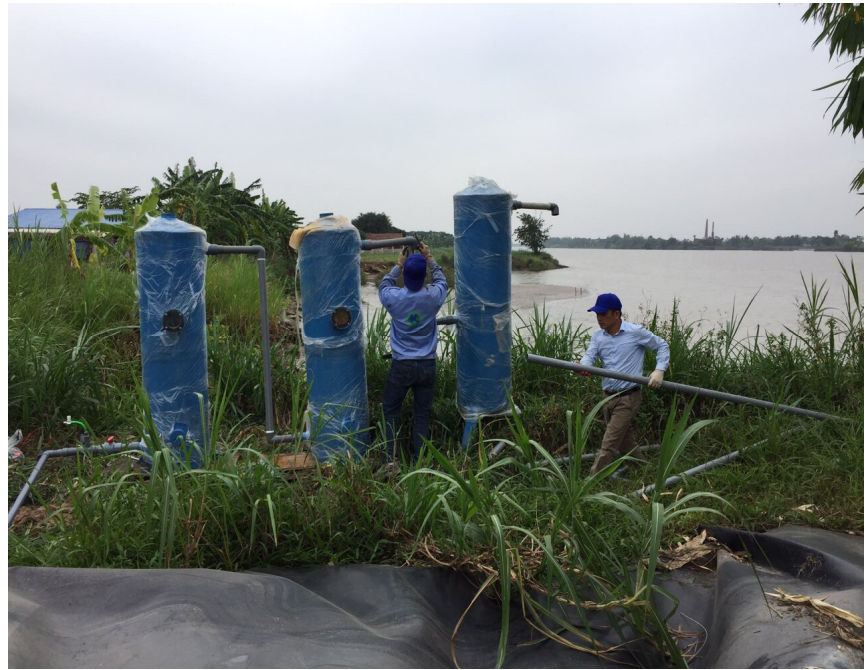
Hình 3. Thử nghiệm hệ thống nhắn tin tự động về thời gian chạy máy và thay thế vỏ lọc bằng thép nhập khẩu bằng vật liệu composite
