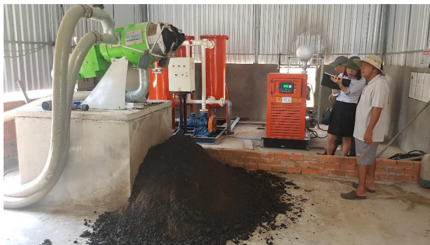
Hình 5: Đầu tư máy phát điện khí sinh học và máy tách ép phân tại trang trại chăn nuôi lợn thịt ở Sóc Trăng
