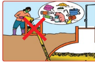
Không cho các tạp chất, hoá chất, chất kháng sinh, dầu mỡ vào bể phân giải
