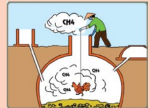
Kiểm tra chắc chắn khí ga không còn trong bể trước khi xuống bảo dưỡng (đo bằng máy hoặc thả một con vịt con sông xuống bể,...)
