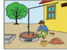
Thường xuyên giữ ẩm lớp đất sét trên cổ bể phân giải (đối với bể xây)
