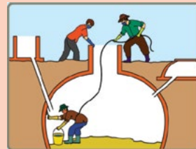
Thắt dây an toàn khi xuống bảo dưỡng. Luôn có người đứng hỗ trợ trực tiếp bên trên bể
