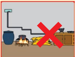
Không lắp đường ống đi qua những nơi dễ cháy nổ để dễ phòng hoá hoạn
