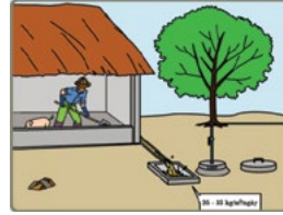
Nạp nguyên liệu không vượt quá công suất thiết kế của hầm (khoảng 25-33kg/m 3 /ngày)
