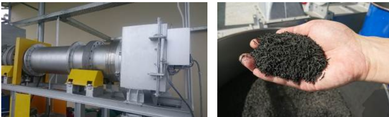
Hình 6. Ảnh chụp lò quay (trái) và phân xốp sau khi đốt (phải)
