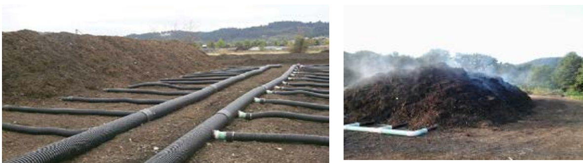
Hình 4. Mô hình xử lý chất thải có thổi khí cưỡng bức
